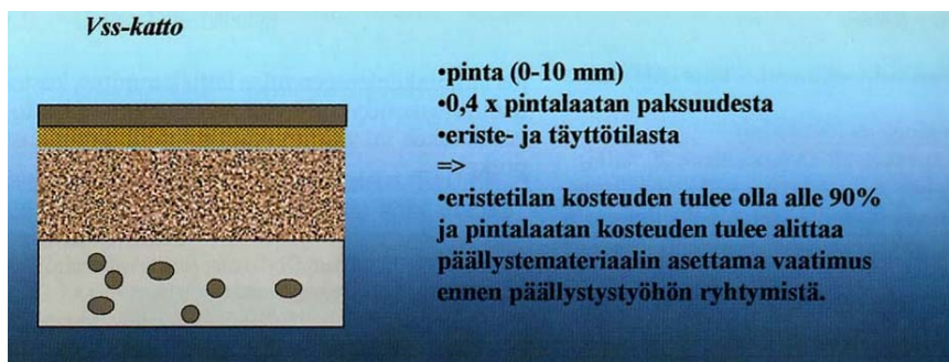
Kuva 20. Oikeat mittaussyvyydet väestönsuojan kattorakenteille /6/
