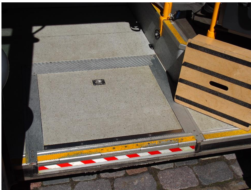
Kuva 3. Sisätilan lattiaan taitettava ramppi ja porras.
