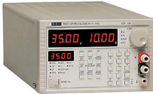
Kuva 10. Tti TSX1820P -teholähde.
