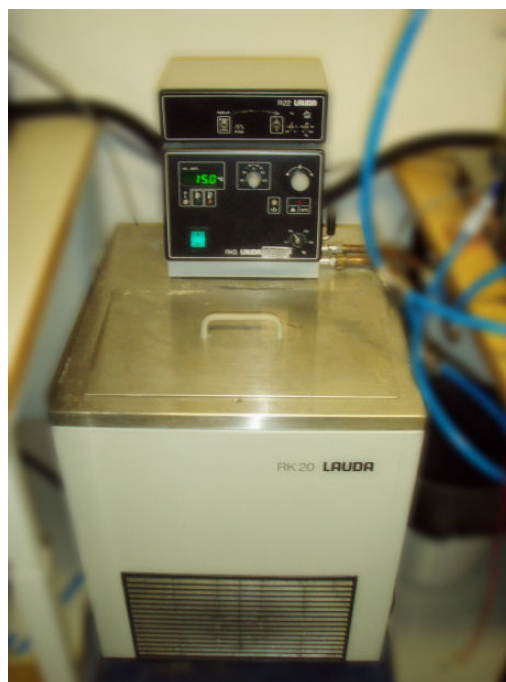
Kuva 4. Lauda RKS20-D -vesitermostaatti ja R22-säädinjärjestelmä. R22-säädinjärjestelmä ei ollut kytkettynä toimintaan.
