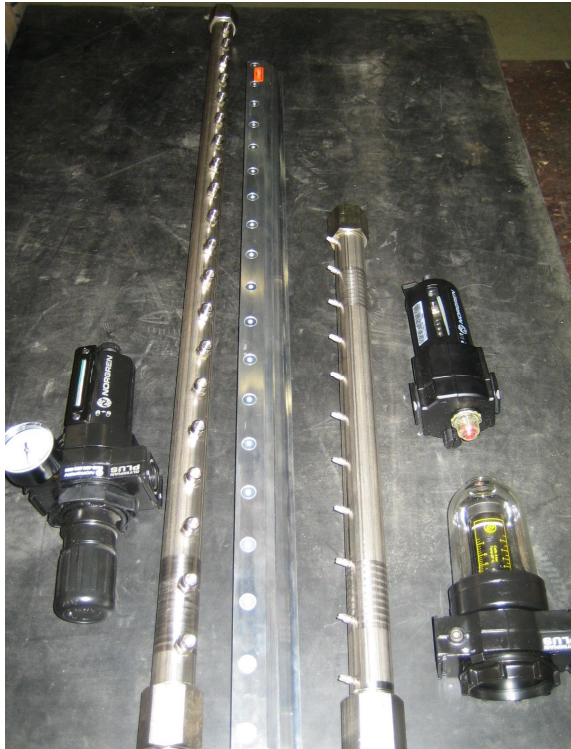
Kuva 8. Vasemmalta oikealle: paineensäädin, puhallusputki vaihdettaville suuttimille, ilmaveitsi, reunanauhatorven mallipuhallusputki suuttimilla, sumuvoitelulaite ja virtausmittari
