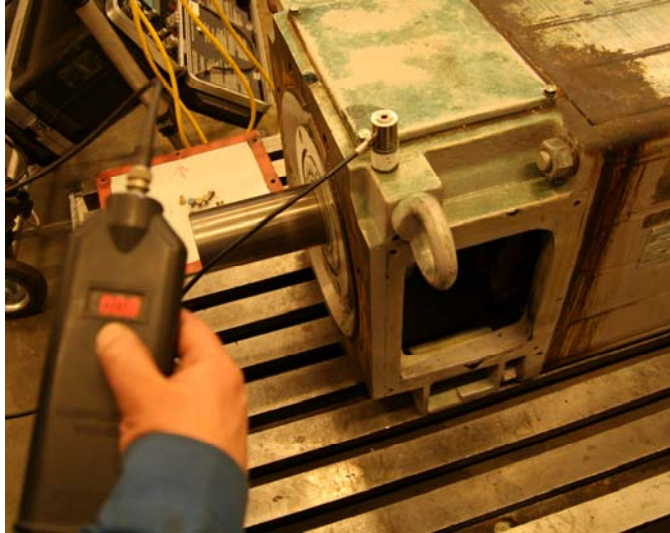
Kuva 46 Pystysuuntaisen tärinän mittaaminen
