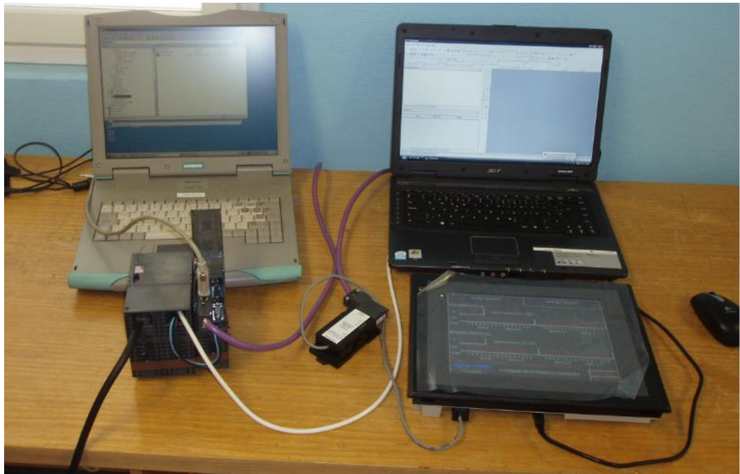
Kuva 22 Näytön testaus kytkettynä PLC:hen
