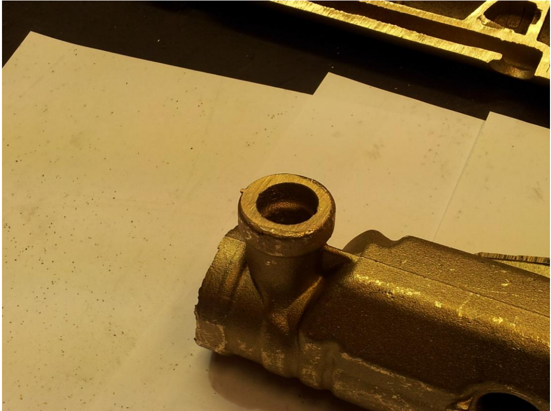
Kuva 23. Hiomalla tasoitettu aukon pinta
