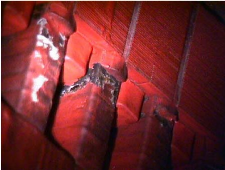
Kuva 10 Eristeen hiiltyminen pintavirtojen seurauksena /9/
