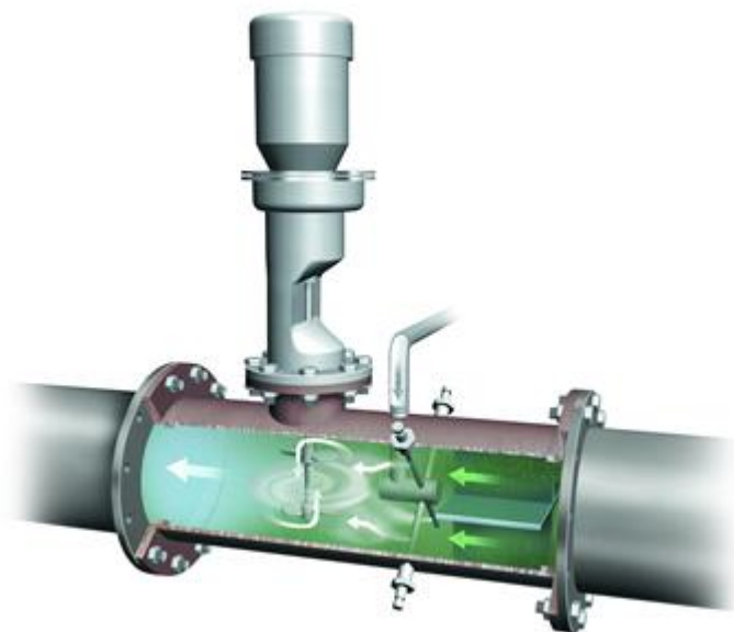
Kuva 10. InstoMix dynaaminen putkisekoitin nestemäisen kemikaalin syötöllä. Kemikaalin syöttö tapahtuu reiällisillä putkilla juuri ennen kahta eri suuntiin pyörivää sekoitinta. [Walker Process Equipment 2012]
