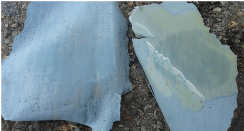
Kuva 51. Öljymaali kellastuu ja liukenee lipeässä, talousspriillä on pelkästään maalipintaa puhdistava vaikutus. (Jani Wilhola 2015.)
