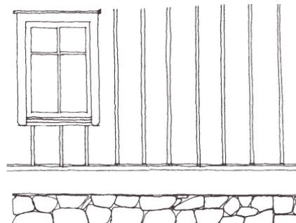
Pystyvuorin helma on korjattu vaakalaidoituksella. Uuden ja vanhan laudoituksen liittymäkohtaan on laitettu vesilauta.
