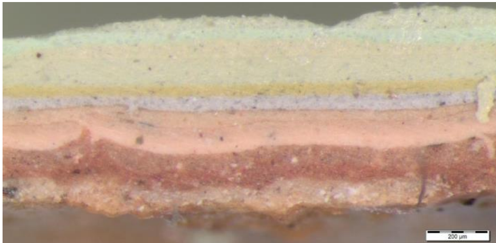
Kuva 44. Laboratoriossa analysoitu maalilastu antaa varhimman tuloksen käytetyistä pintakäsittelytuotteista. (Jani Wilhola 2015.)
