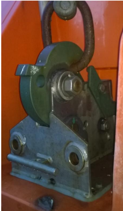
Kuva 8. On-load release gear/automatic release hook
