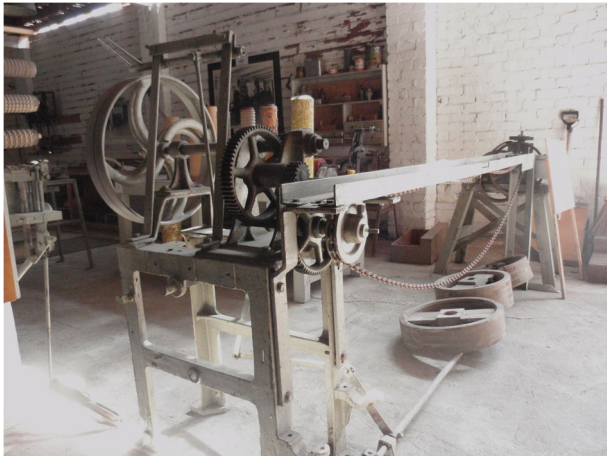
18. Metallintyöstökone painotelojen valmistukseen (lev. 2900 x syv. 950 x kork. 1450)
