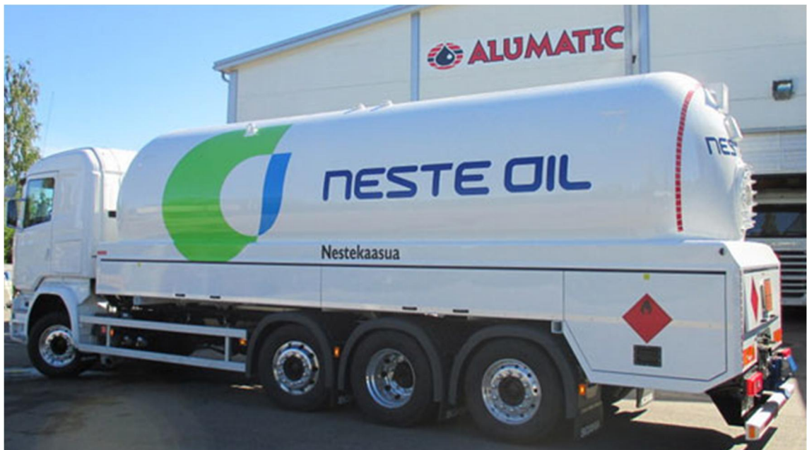
Kuva 2. Esimerkki sivukaapistoista, jotka estävät tyhjennysatulan käytön (Alumatic Oy).
