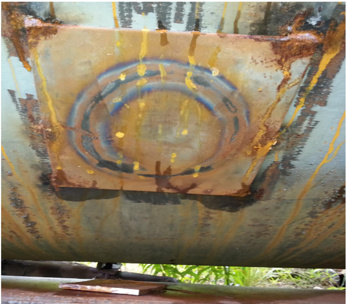
Kuva 4. Poraussimulaattori säiliön pinnassa (porauskohta ympyrän keskellä, teräslevyn paksuus 3 mm).
