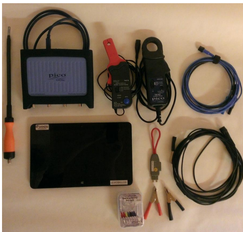
Kuva 12. PicoScope 4425 digitaalioskilloskooppijärjestelmän tärkeimmät osat. Vasemmalta coil on plug mittapää, Picoscope, tabletti, jolla oskilloskooppiohjelmia käytetään, kaksi erilaista pihtivirtamittaria ja erilaisia mittakaapeleita sekä mittapäitä.
