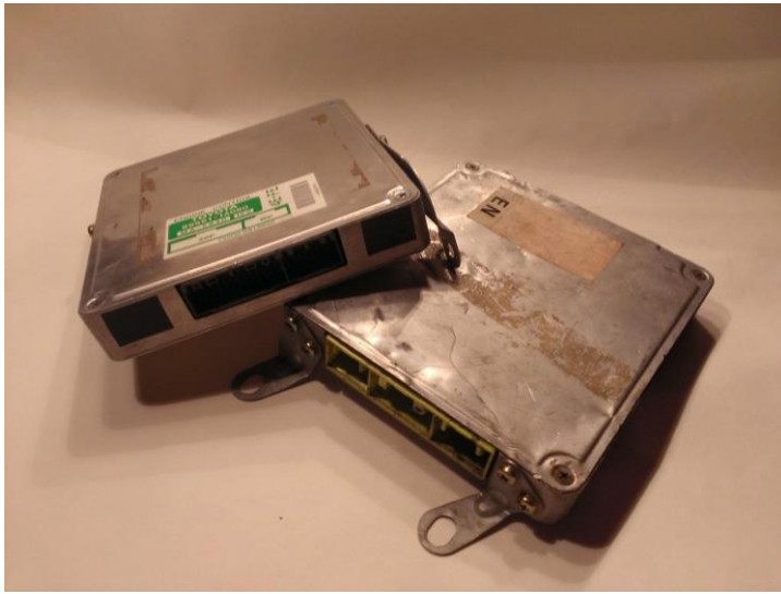
Kuva 5. Toyotan käyttämiä moottorinohjainlaitteita 1990-luvulta.
