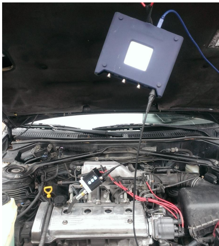
Kuva 13. WPS500X-paineenmittausadapteri kytkettynä oskilloskooppiin sylinterinpuristus-painetestiä varten.
