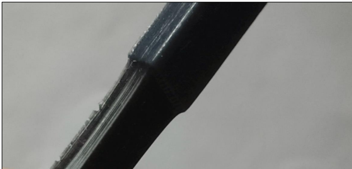
KUVA 21. Kiiltäväpintainen päittäisliitoksen sauva venytyksessä (Laaksonen 2016)
