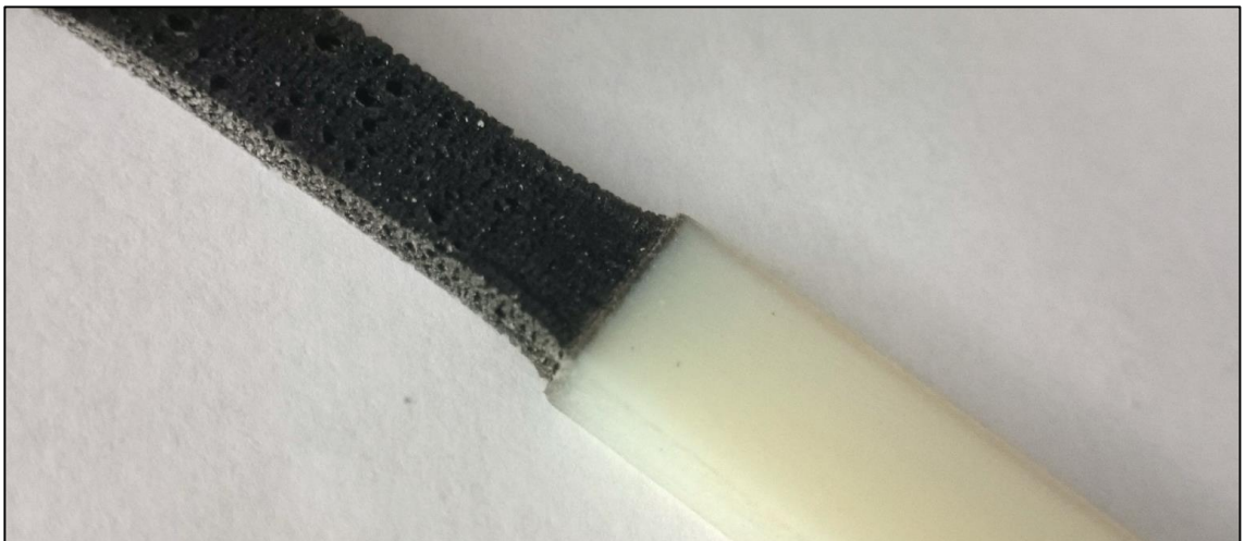
KUVA 20. Mattapintainen päittäisliitoksen sauva venytyksessä (Laaksonen 2016)
