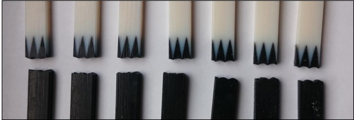
KUVA 16. Vetosauvojen murtumiskohdat (Laaksonen 2016)
