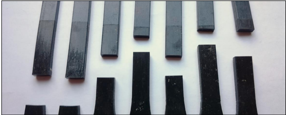
KUVA 12. Vetosauvojen murtumiskohdat (Laaksonen 2016)
