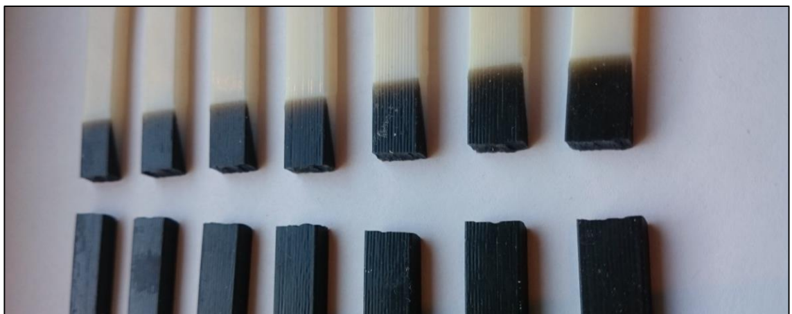
KUVA 14. Vetosauvojen murtumiskohdat (Laaksonen 2016)
