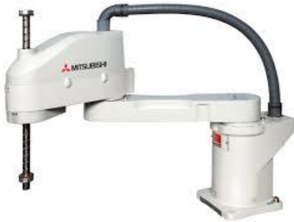
Kuva 3 Mitsubishiin kokoonpanotyöskentelyyn suunnittelema SCARA-robotti
