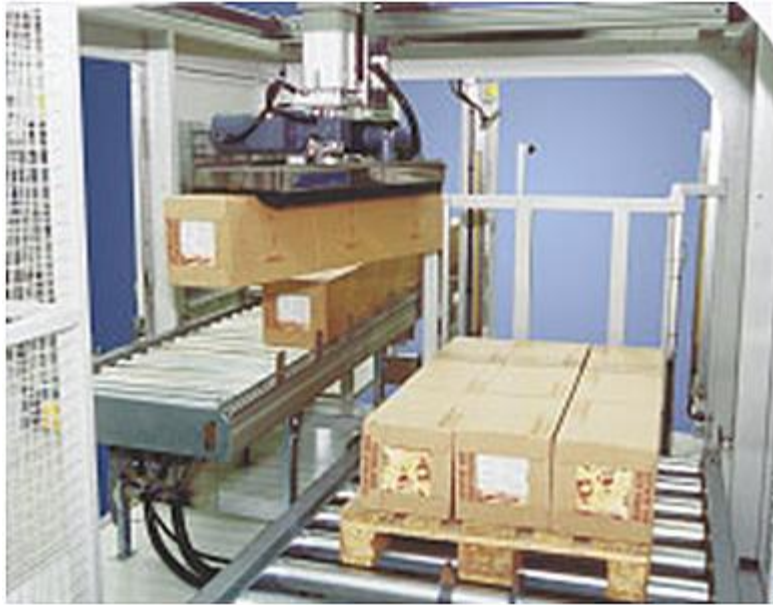
Kuvio 2: Jomet Oy:n automaattinen lavoitusjärjestelmä ( www.jomet.fi/?pageid=70&parent0=3 , 2009)
