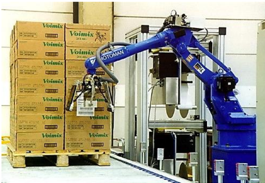
Kuvio 1: Done Logistics Oy:n automaattinen lavaus- ja etiketöintijärjestelmä (www.donelogistics.com/S/Lavaus.htm, 2009)
