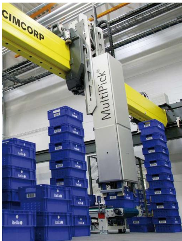
Kuvio 4: Cimcorp-yhtiön MultiPick varaston ja lavauksen hallintajärjestelmä
