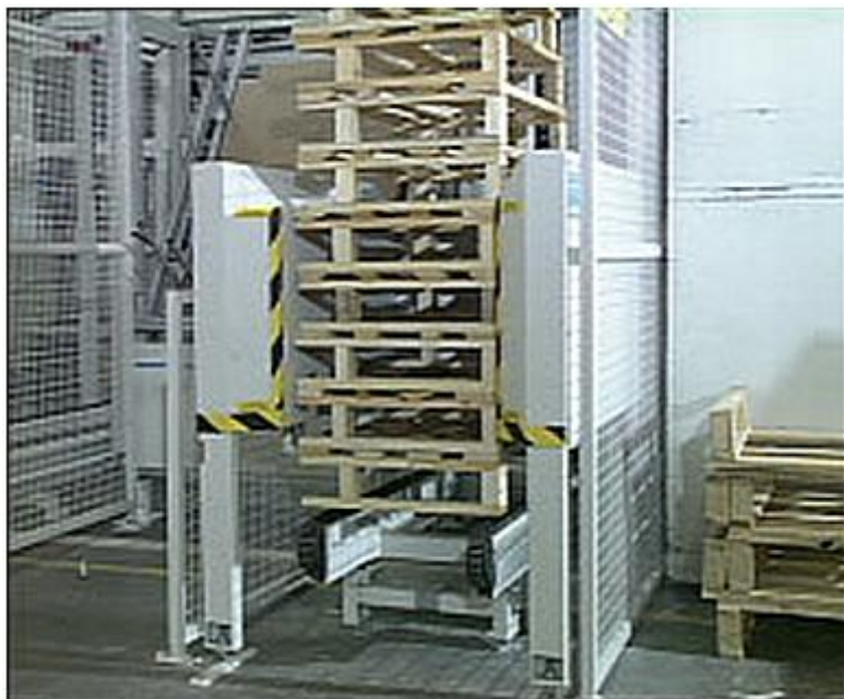
Kuvio 3: Jomet Oy:n automaattinen kuormalavojen käsittely-järjestelmä ( www.jomet.fi/?pageid=70&parent0=3 , 2009)
