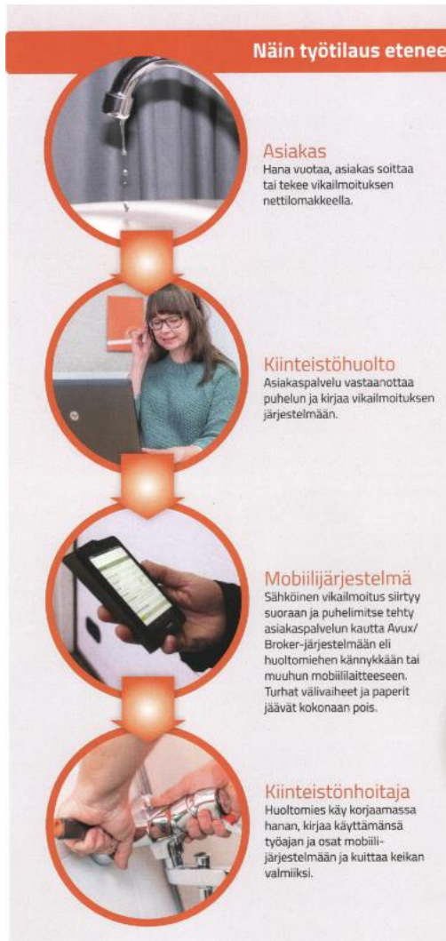
Kuva 7. Työtilauksen eteneminen (PTH Kiinteistöpalvelut. 2017)
