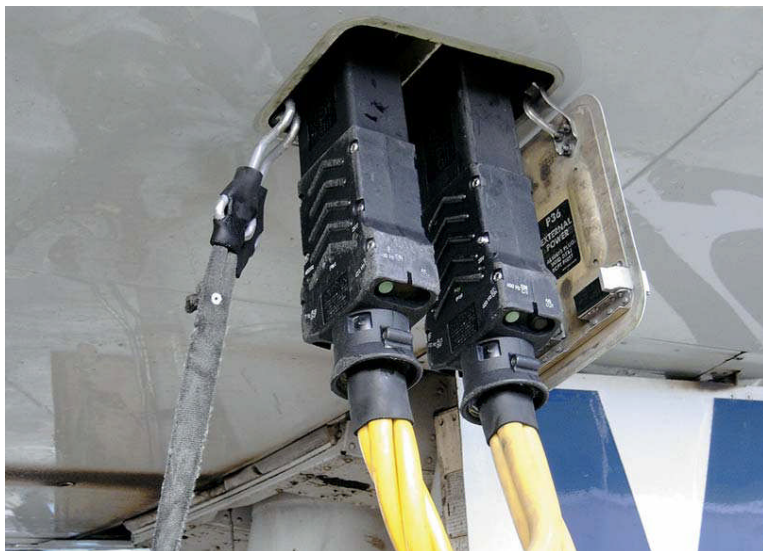
Figur 15. Två stycken 400Hz anslutningspluggar kopplade till ett flygplan
