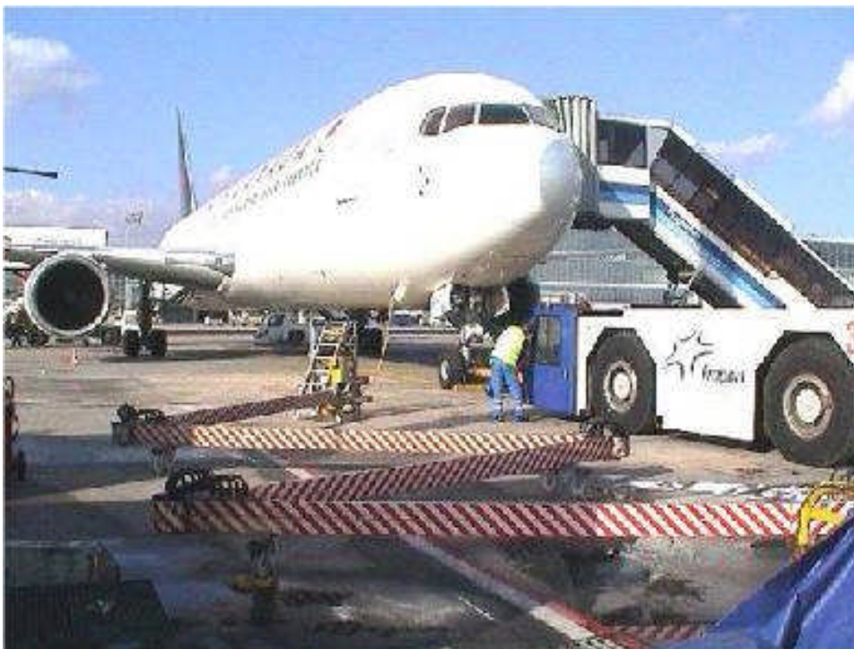
Figur 5. "Scissors"-systemet anslutet till ett flygplan
