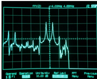
Figur 8. Frekvensanalys av utsignalen från en blandare. (Oscilloskop: Hewlett Packard 54600A 100 MHz)
