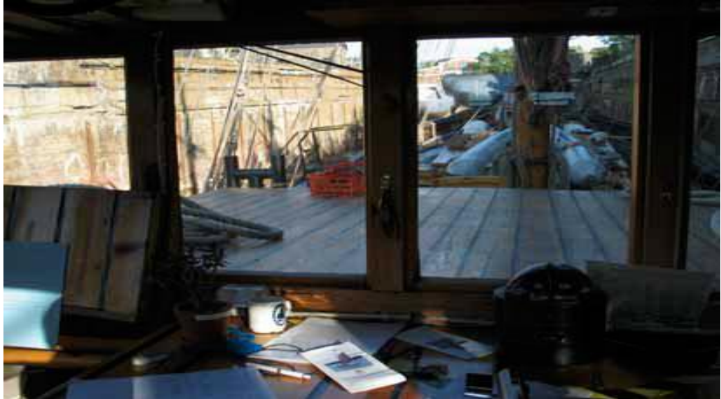
Kuva 7. Näkyvyys oli hyvä aluksen komentosillalta eteenpäin. Kompassi on aluksen keskilinjalla. (© Onnettomuustutkintakeskus)
