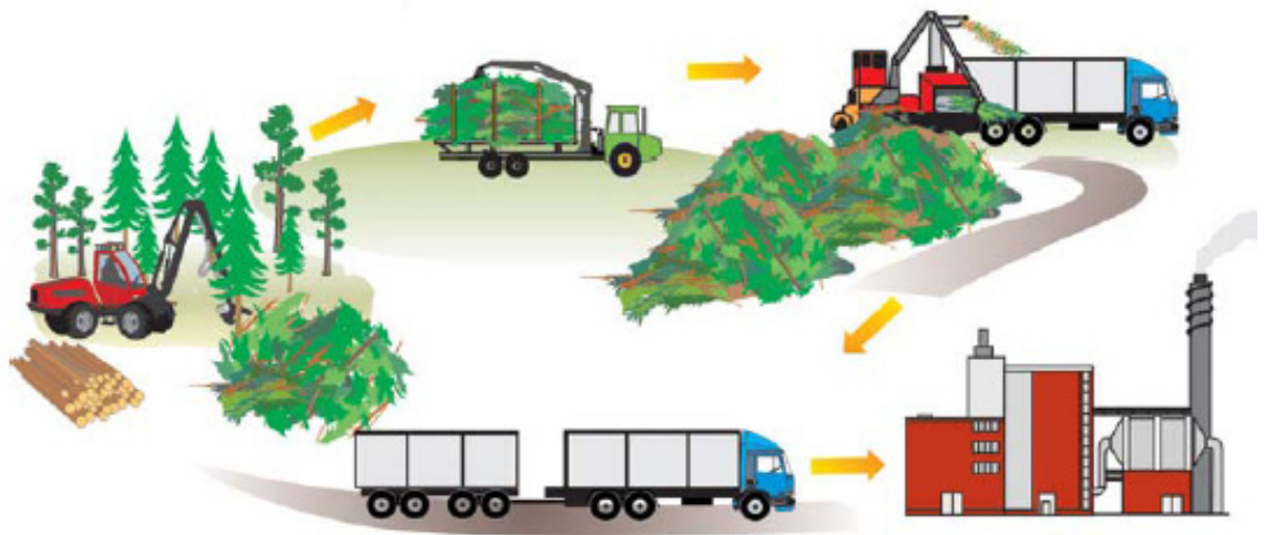
KUVA 12. Hakkuutähteiden haketus. (Hakkila 2004.)
