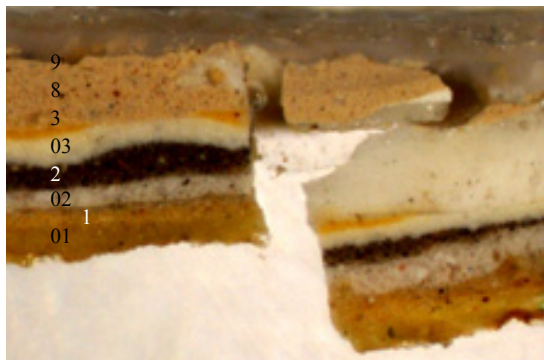
Ikkunan vuorilaudoitus, palmetin ulkoreuna (PyIVu12_4x). Kerroksia puuttuu.
