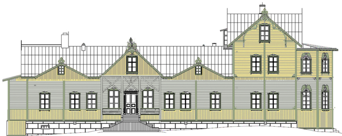
Kuva 13. Julkisivu kaakkoon. Pytingin seitsemäs värikerros. Seinäpinnan vaakalaidoitettu alempi seinäpaneeli on harmaansininen ja muuten seinä on vaaleankeltainen. Listoitus on harmaanvihreä.
