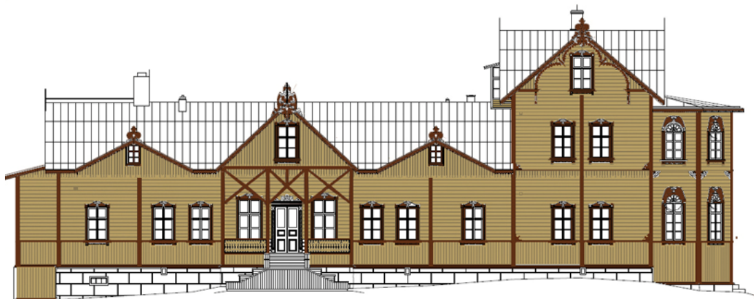
Kuva 7. Julkisivu kaakkoon. Pytingin neljäs värikerros. Seinäpinta on kellanruskea ja listoitus ruskea. Avoparveke on ummistettu ja savupiippuja mahdollisesti purettu kuvan mukaisesti.
