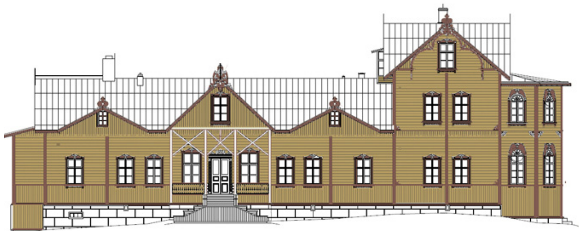
Kuva 9. Julkisivu kaakkoon. Pytingin viides värikerros. Seinäväri on sama kuin neljännessä värikerroksessa. Listoitus on roosa ja avoverannan pilasterit vaaleanharmaanruskeat.
