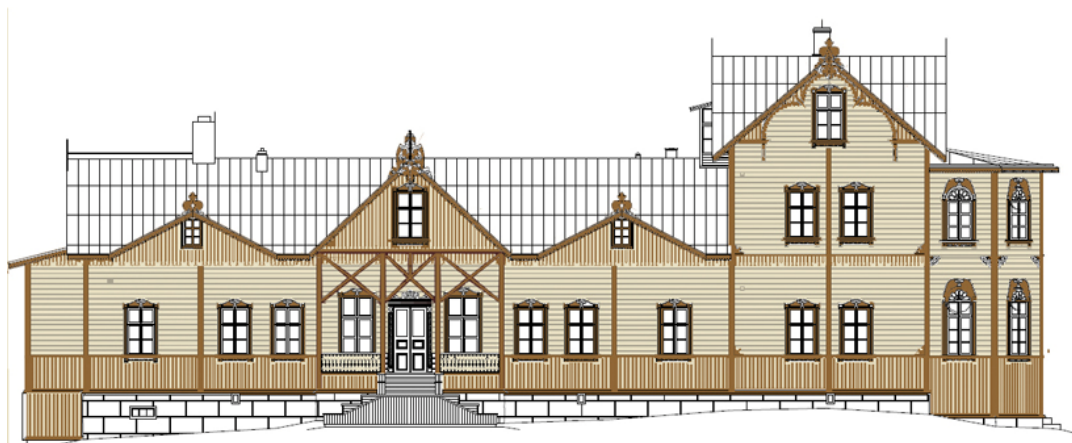
Kuva 5. Julkisivu kaakkoon. Pytingin kolmas värikerros. Seinä ovat kellanvalkoinen ja listoitus kellanruskea, samoin kuin rintapaneelin ja ylemmän seinäpaneelin pystyrimalaudoituksen rimat. Koillispäädyssä pitäisi olla avoparveke, joka on vasta myöhemmin ummistettu.
