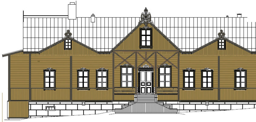
Kuva 1. Julkisivu kaakkoon. Pytingin ensimmäinen värikerros ennen vuoden 1898 tornimaista laajennusta. Seinäpinnat olivat vaaleanruskeat ja listoitus tummanruskea. Julkisivuun kuului huopakatteinen aumakatto, avoverannan yläosaan helmalaudoitus ja katolle kolme savupiippua (vrt. liite 1, kuva 2).
