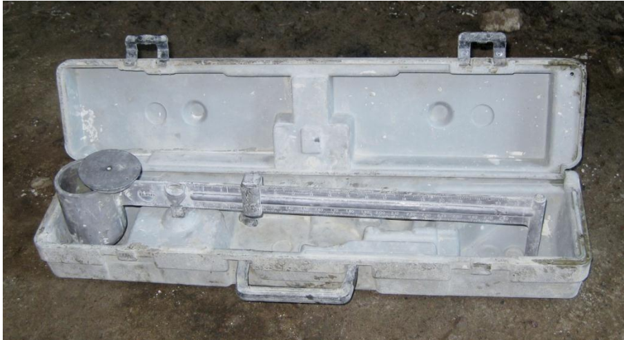
Kuva 5. Tutkimuksissa käytetty mud balance mittalaite
