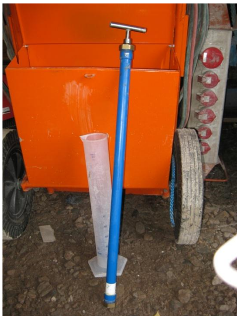
Kuva 12. Tunkeuman mittauspumppu ja mittalasi
