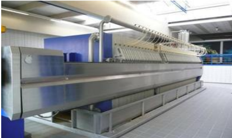
Kuva 10. Meura 2001:een mäski ja huuhteluvesi syötetään alakautta. Vierre poistuu paineilman avulla ylhäällä näkyvästä putkesta vierrekattilaan. (www.wallart.fr 2012)
