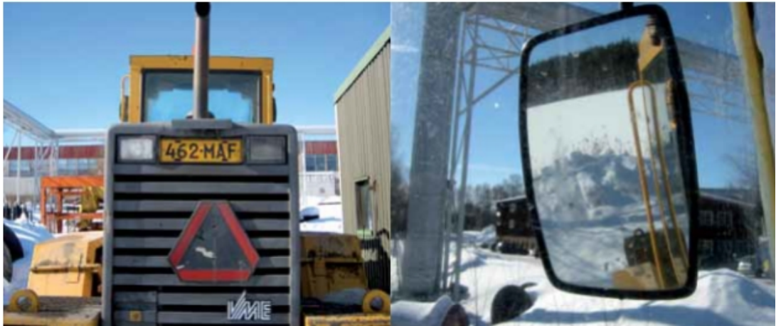
KUVIO 6. Työkoneen rakenteen aiheuttama näkemäeste
