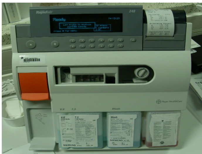
KUVIO 16. RapidLab 248 -verikaasuanalysaattori Kätilöopiston sairaalan laboratoriossa (Oksala 2008).
