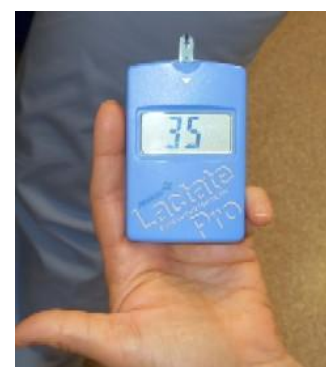
KUVIO 19. Lactate Pro-mittari, jossa 35 sekuntia tuloksen ilmoittamiseen. (Narkiniemi 2009.)
