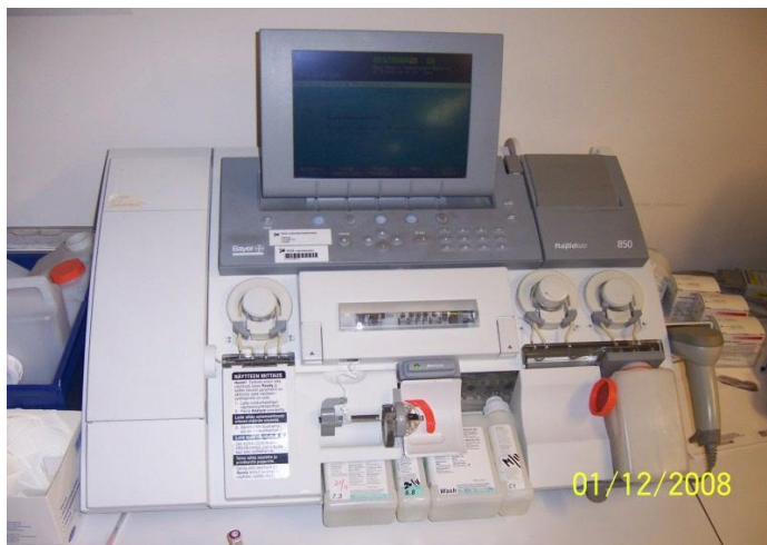
KUVIO 15. RapidLab 865 -verikaasuanalysaattori Kätilöopiston sairaalan laboratoriossa. (Narkiniemi 2008.)
