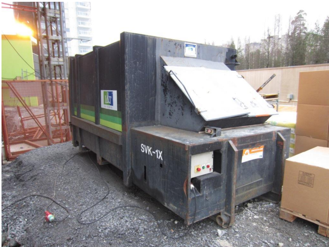
KUVA 6. Työmaan energiajätepuristin. (Suoniemi 12.11.2013)
