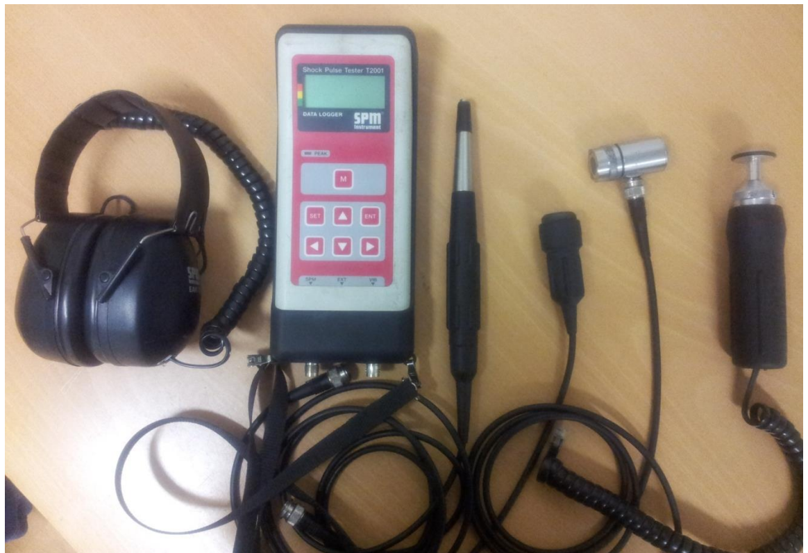
Kuva 23. Mittauslaite Shock Pulse Tester T2001 ja siihen kuuluvat osat: kuulokkeet, käsi-koetin, iskusysäysanturi, tärinäanturi ja kierroslukuanturi.
