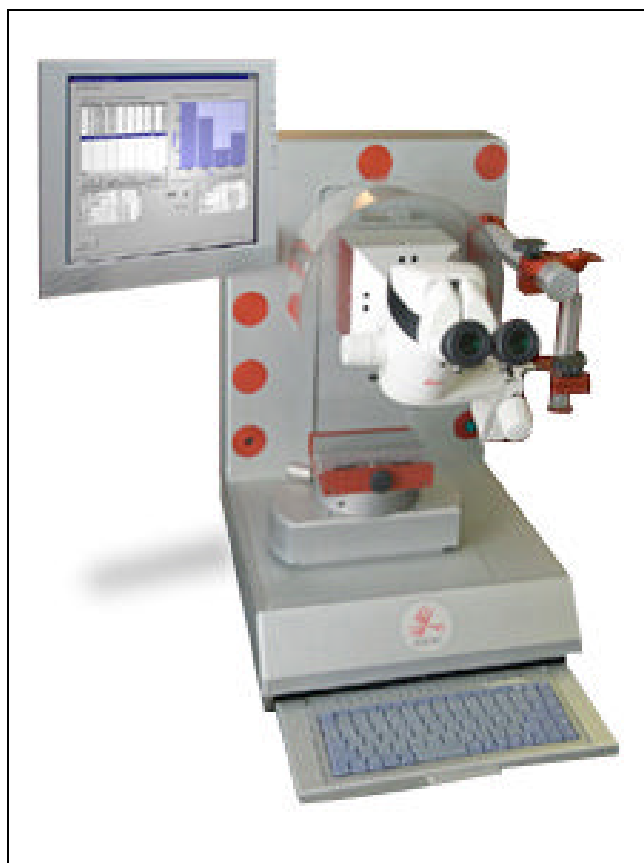
Kuva 25. Veto- ja leikkauslujuuden testauslaite [22.]
