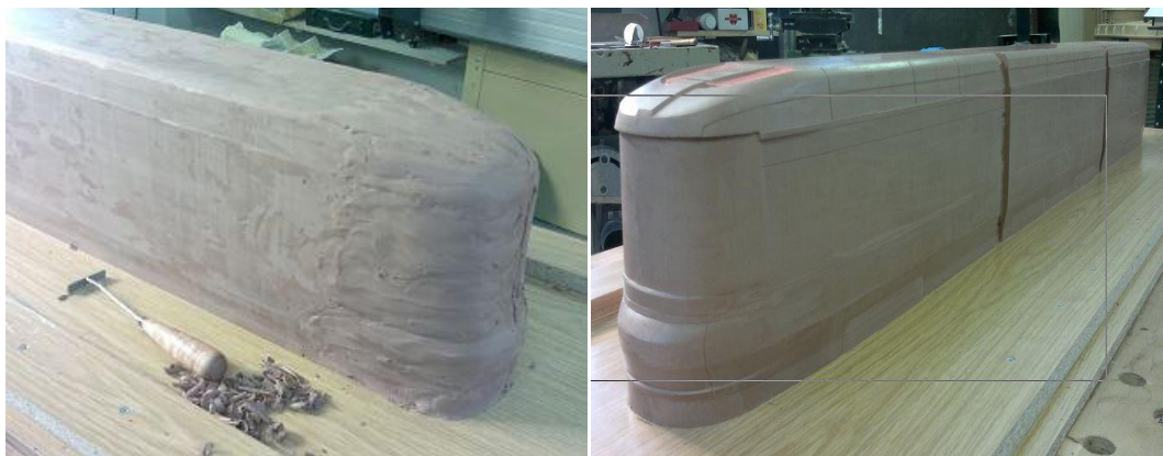
Kuva 6. Työstettävänä oleva ja valmis vahamallinnus raitiovaunu pienoismallista.
