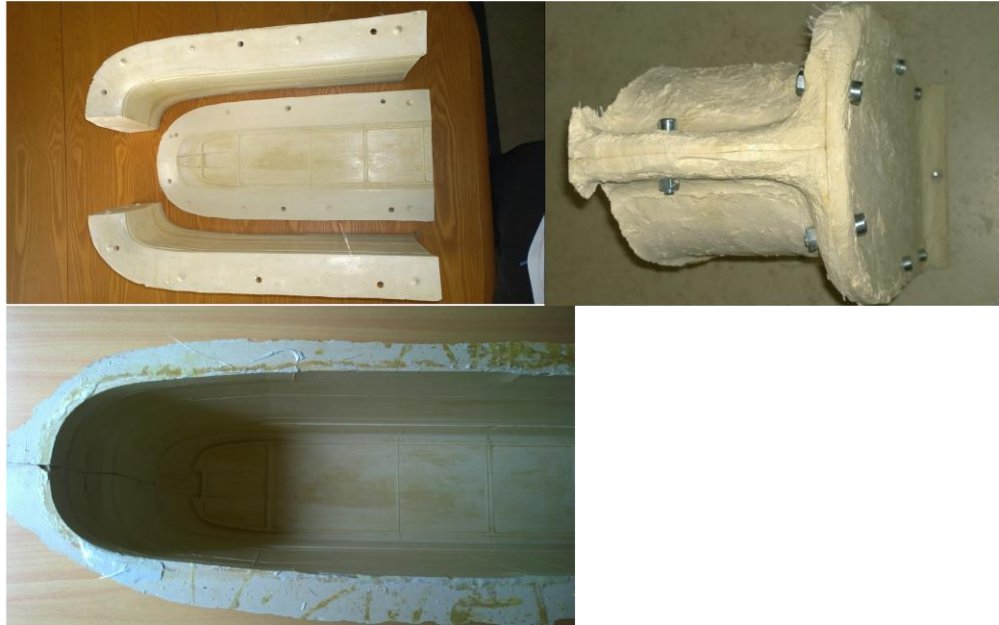
Kuva 7. Kipsivaiheessa olevat mallit. Kuvissa käytetty Helsingin raitiovaunun pienoismallia.
