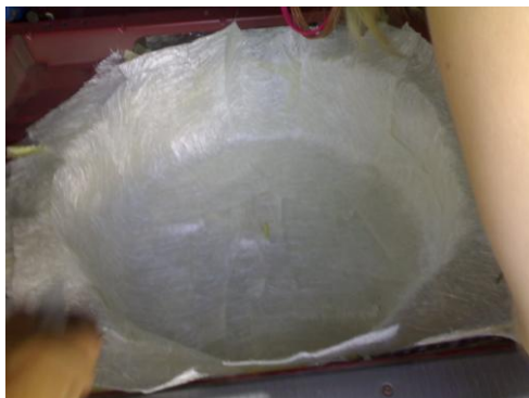
Kuva 8. Lasikuitukerros asetetaan kipsimuotin sisäpinnalle.
