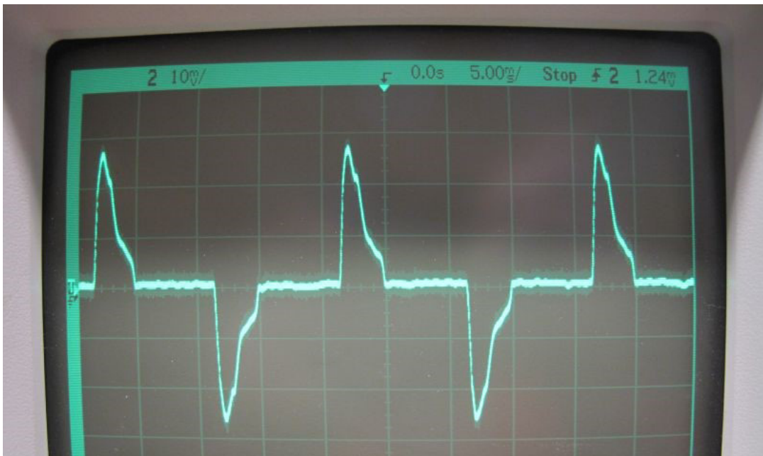
Kuva 4. Loistelamppu 2:n virta ajan funktiona.
