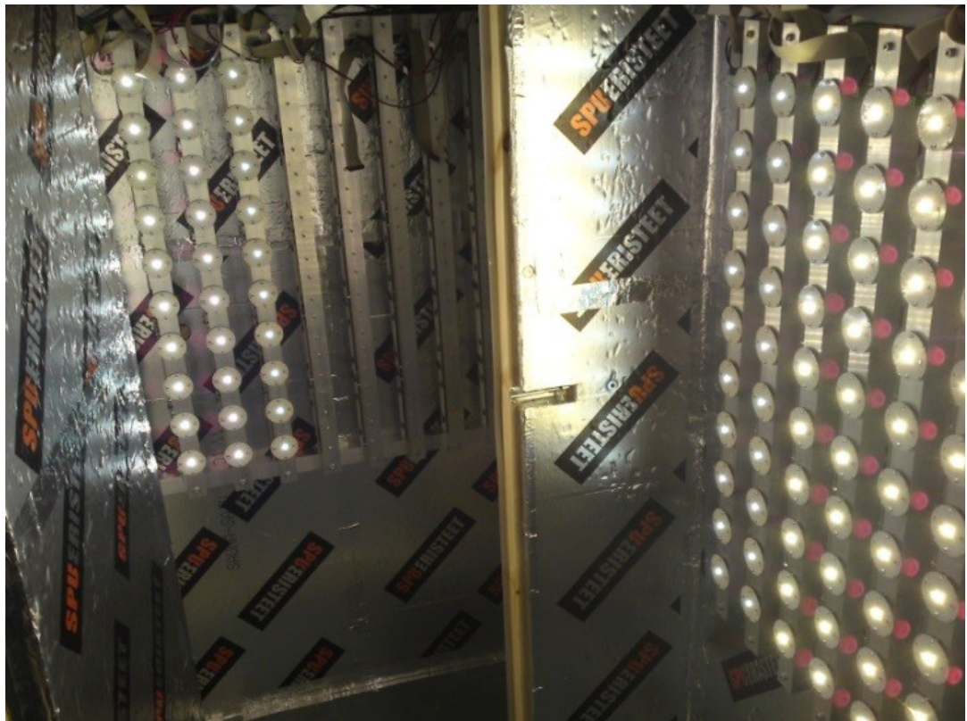
Kuva 2. Kohotetun lämpötilan testihuone. Etualalla 55 °C:n huone ja taka-alalla 85 °C:n huone.
