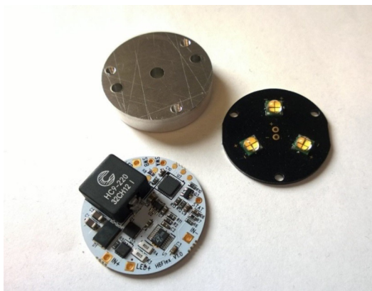
Kuva 6. Led-levy, sen alle tuleva alumiinikiekko sekä ohjausyksikkö.
