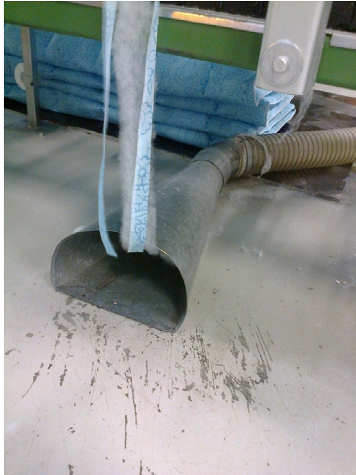
Kuva 4. Yrityksen nro 1 tikkauskoneelta syntyvää ns. reunasoiroa.
