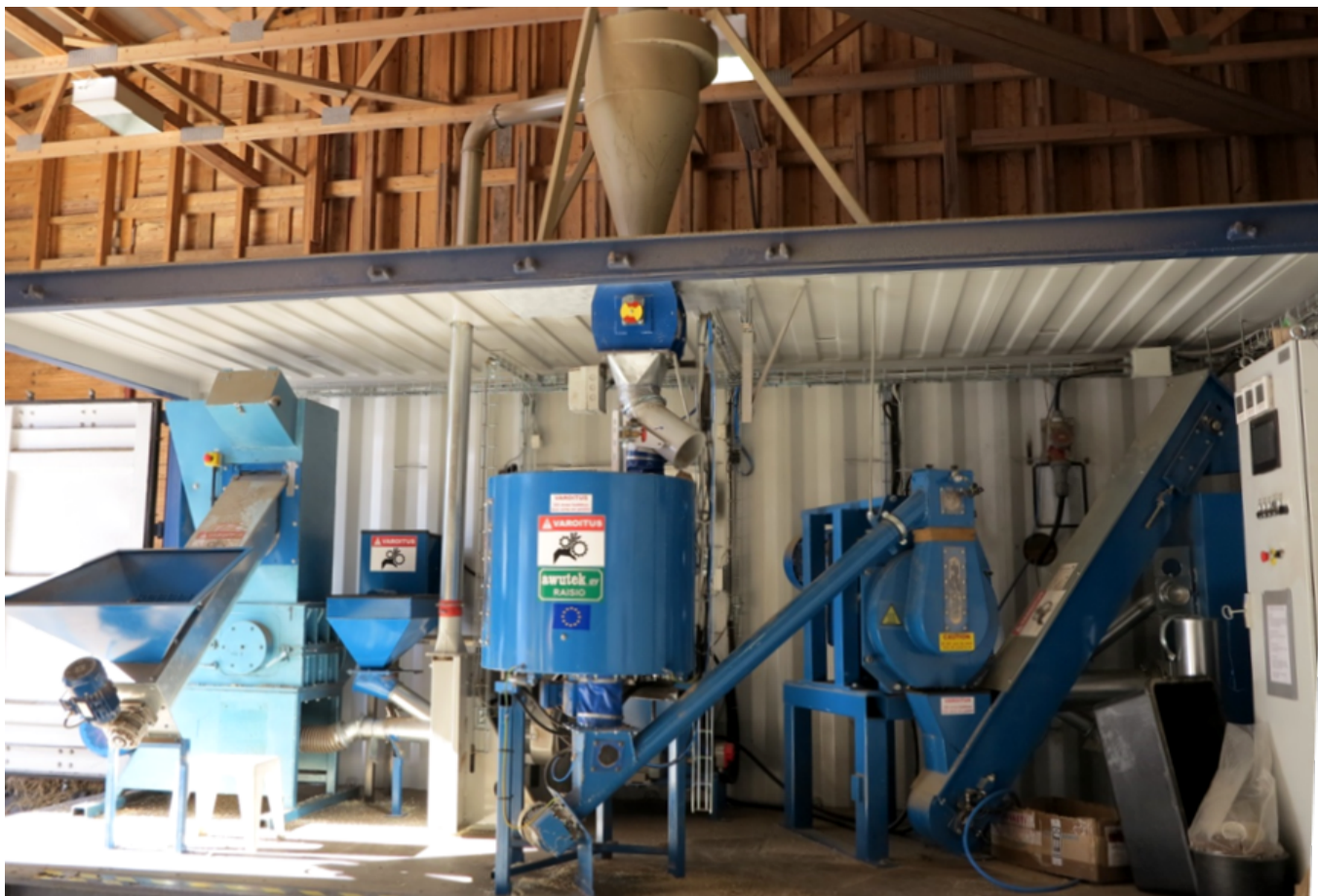
Kuva 1. Merikonttiin rakennettu pelletöintilaitteisto (Kuvaaja: Mikko Aalto)
