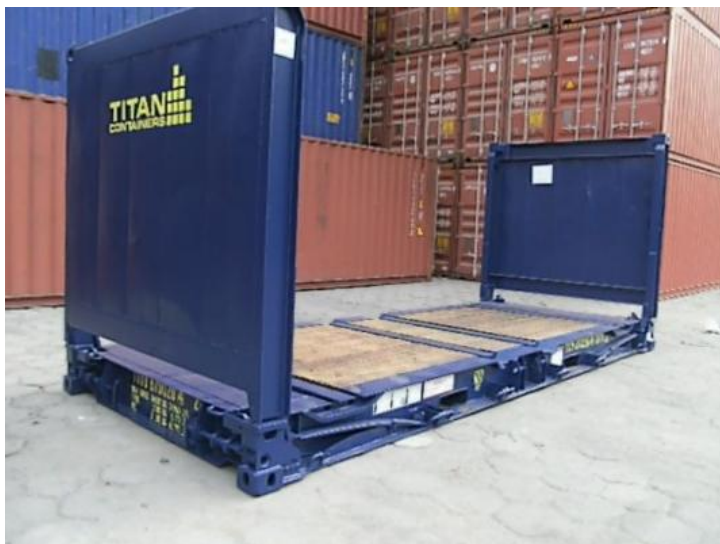
Kuva 6. Suurlava eli flat (Konttitorin www-sivut 2014.)
