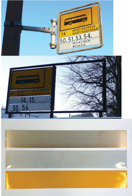
Kuva 8. Turun pysäkkimerkit, alumiinohutlevy ja tarrat.
