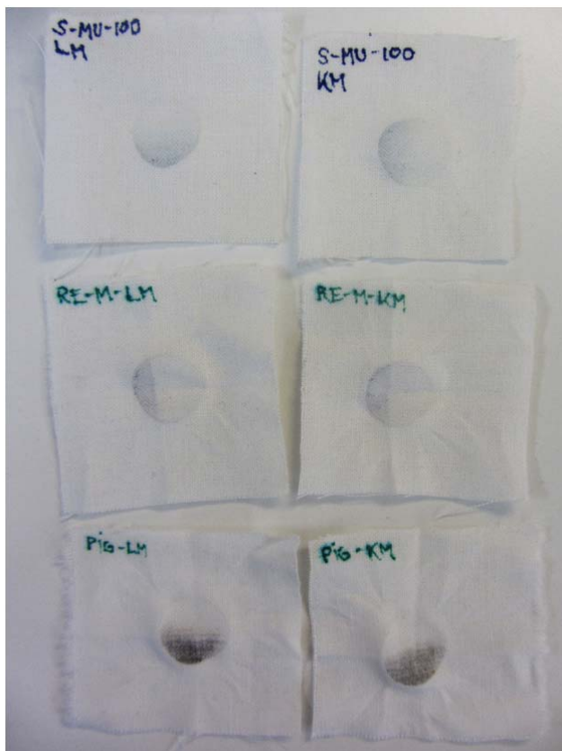
KUVA 18. Reaktiivitulostetun mustan, reaktiivipainetun mustan ja pigmenttipainetun mustan märkien hankauksenkesto arvosanojen testikankaat.
