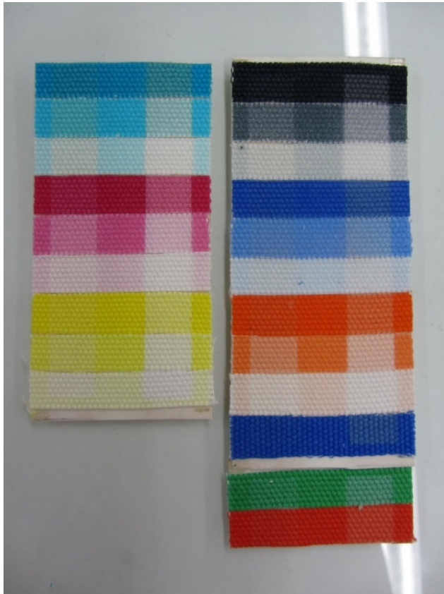
KUVA 21. Puuvillapanaman valotetut näytteet testauksen päätyttyä.
