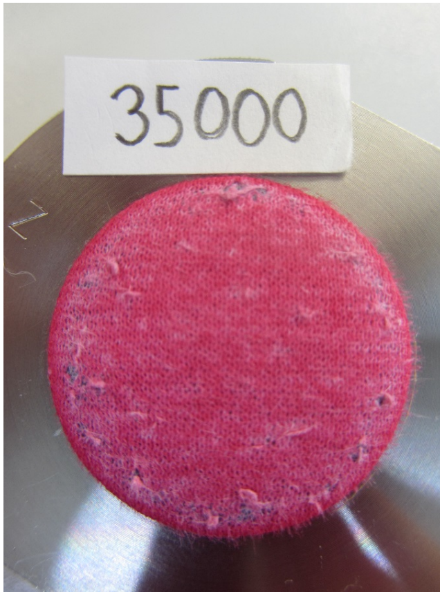
KUVA 27. Näyte 5: Puuvillaneulos 35000 kierroksen jälkeen.
