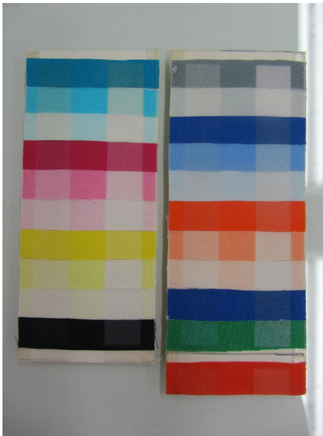
KUVA 22. Puuvillasatiinin valotetut näytteet testauksen päätyttyä.
