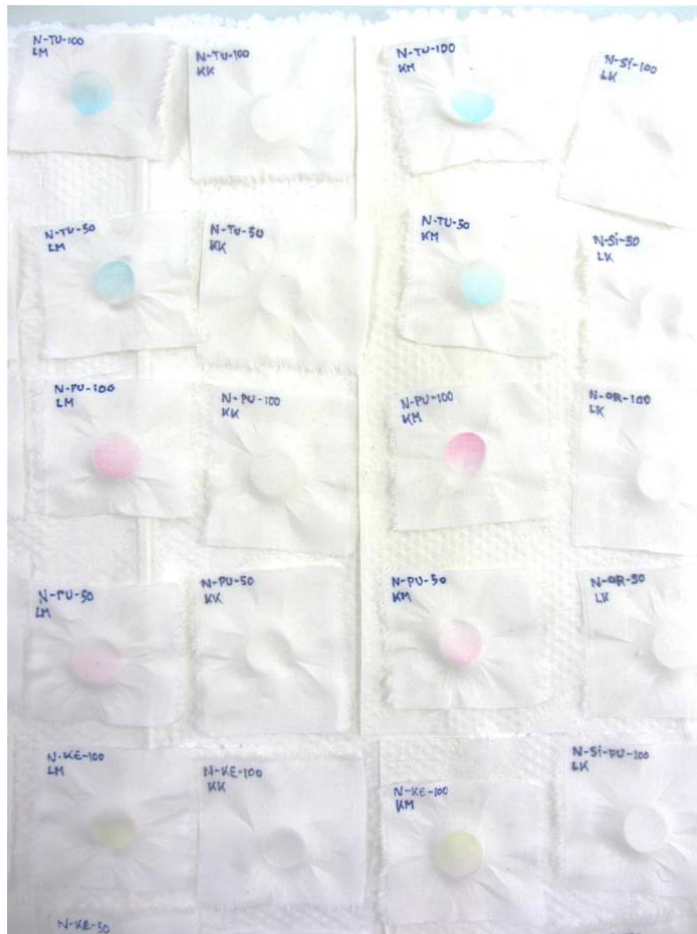
KUVA 17. Puuvillaneuloksen kuivan ja märän hankauksen testikankaita.
