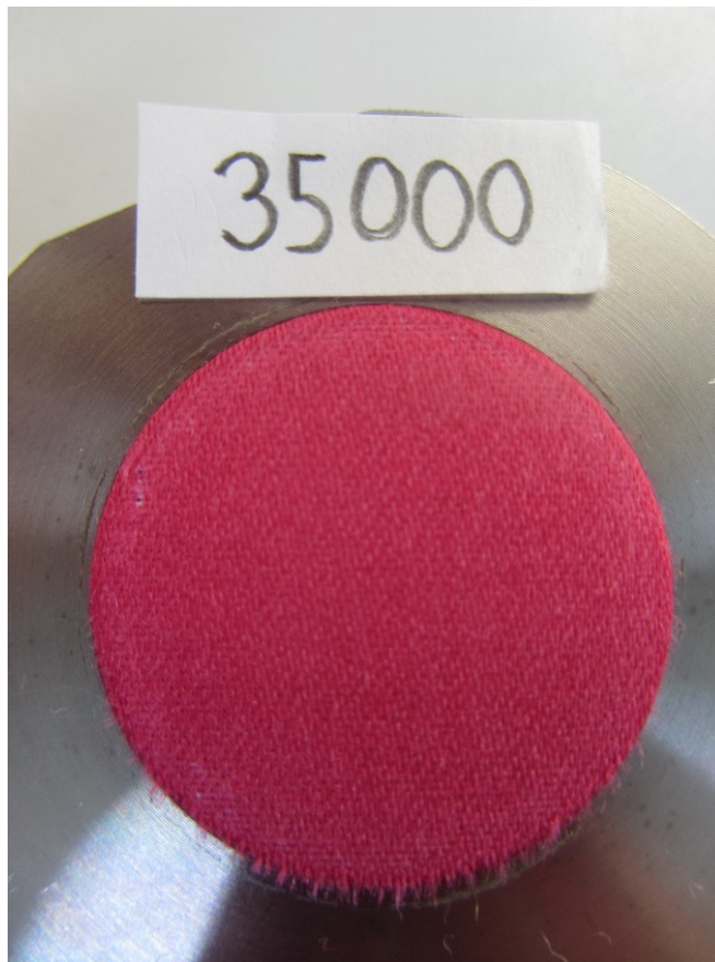
KUVA 26. Näyte 3: Puuvillasatiini 35000 kierroksen jälkeen.
