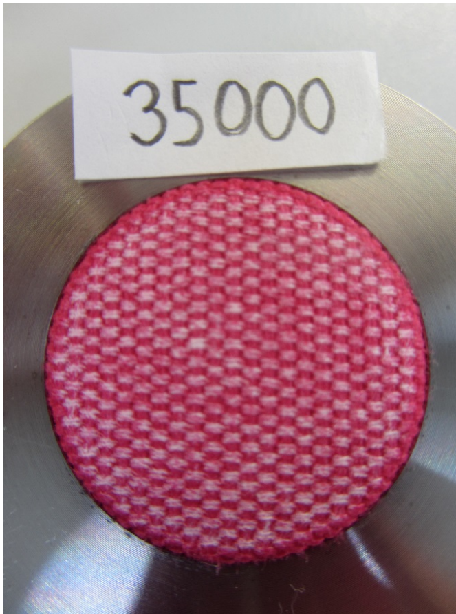
KUVA 25. Näyte 1: Puuvillapanama 35000 kierroksen jälkeen.
