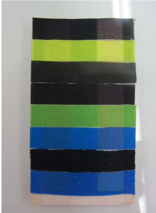
KUVA 23. Vertailunäytteiden valotetut materiaalit testauksen päätyttyä.
