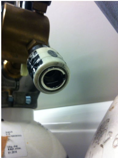
Kuva 12. Paineilmapullon liitettä letkulle. Huomaa pieni lovi sovittimessa. Letku käy sovittimeen vain oikein päin. Happipullon sovittimessa vastaavaa ei ole.
