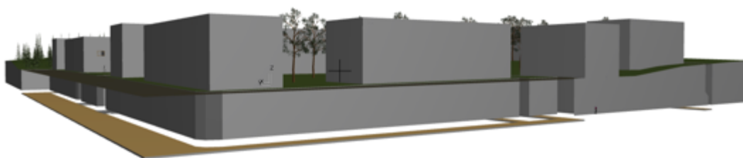
Figur 15. Här syns hur jag eliminerat jordmaterial från solida modellen för att skapa vägar.
