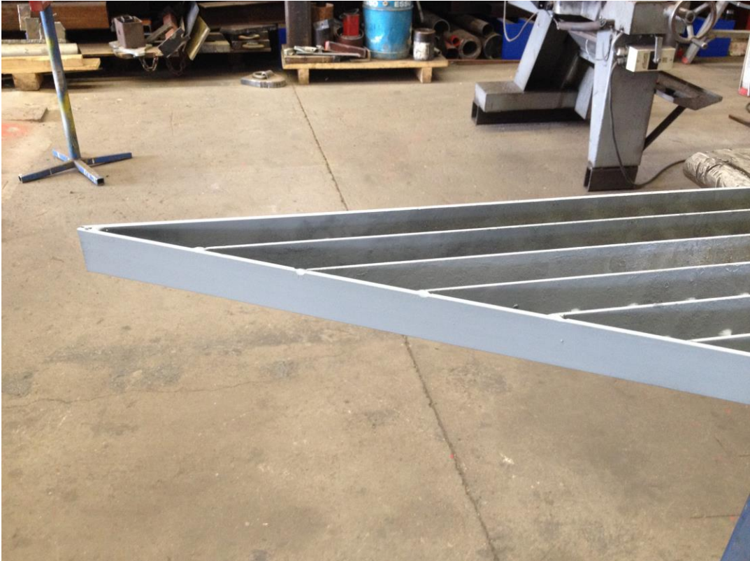
Kuva 26 Paljaat teräspinnat putsattiin ja maalattiin sinkkimaalilla ruosteen estämiseksi.
