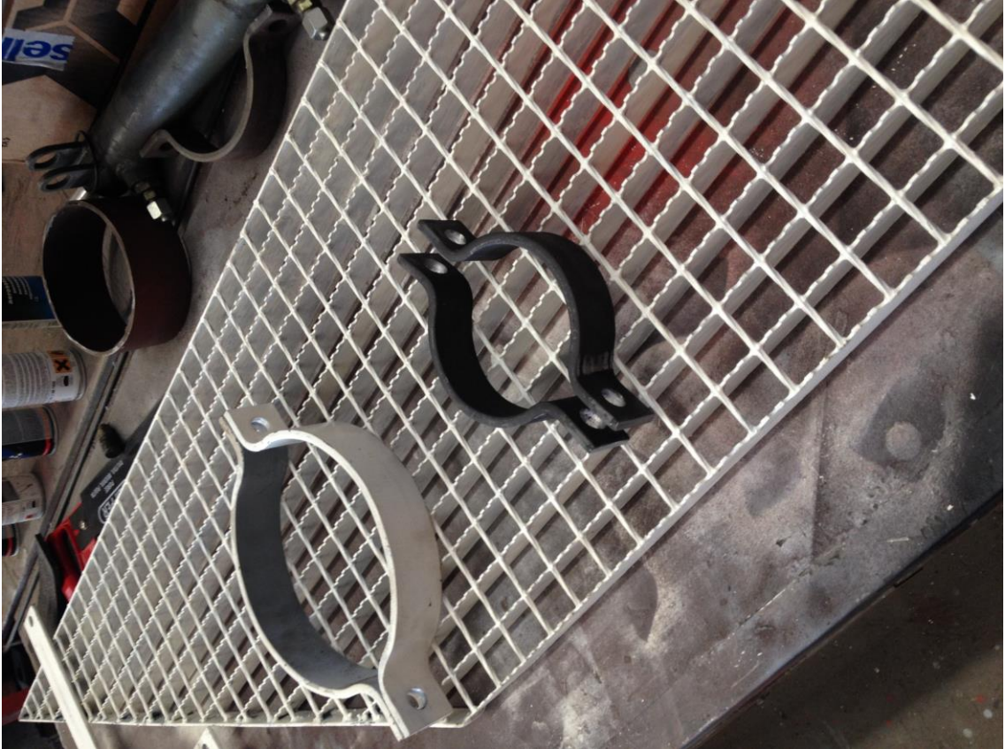
Kuva 21 Kuvassa vasemmalla ristikkopuomin isompiin putkiin kiinni tulevat putkikannakkeet ja oikealla pienempiin putkiin kiinni tulevat putkikannakkeet. Vasemmanpuoleiset kannakkeet on jo käsitelty ruosteenestomaalilla ja valkoisella pintamaalilla. Oikeanpuoleiset kiinnikkeet ovat vielä maalaamatonta terästä.
