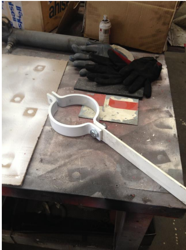
Kuva 31 Putkikannattimet ja teräsprofiilit liitettiin yhteen käyttäen pultteja ja muttereita. Putkikannattimet maalattiin myös sinkkimaalilla ja valkoisella maalilla.
