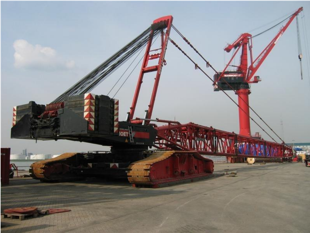
Kuva 11 Liebherr LR1750-merkkinen ristikkopuominosturi kokoamisvaiheessa. Harukset on kiinnitetty nosturin puomin päähän ja väkipyörään, joka on apupuomissa. Väkipyörän vaijeria vinssataan kireämmälle ja puomi nousee pikkuhiljaa pystyasentoon. [17.]
