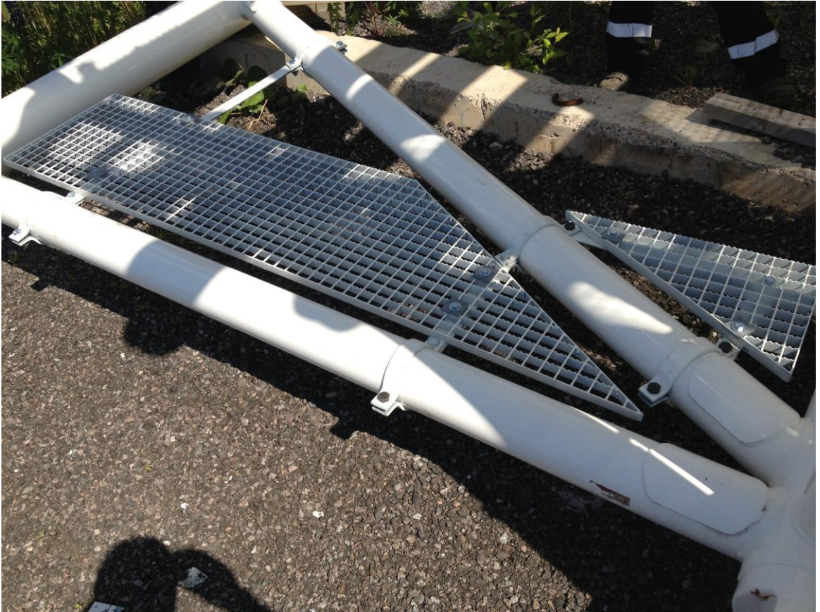
Kuva 33 Turvataso on asennettuna kiinni nosturin puomiin. Kuvan ottamisen jälkeen tason isompaan osaan asennettiin vielä yksi tukirauta keskivaiheille, jotta tasosta saatiin tukevampi.
