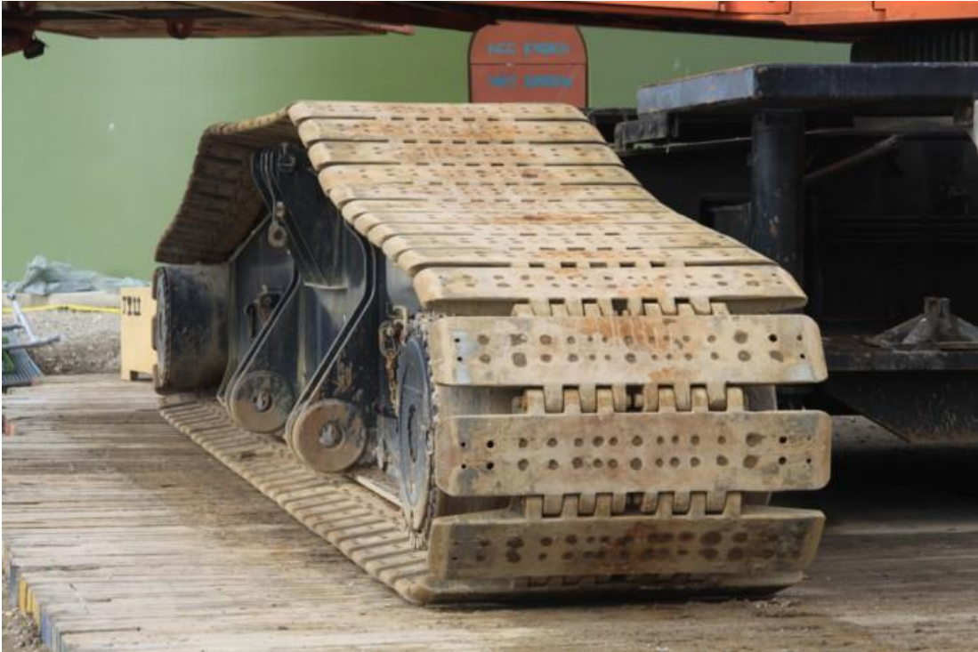
Kuva 9 Liebherr LR1750 -mallisen nosturin toinen tela kiinnitettynä alavaunun runkoon. [15.]
