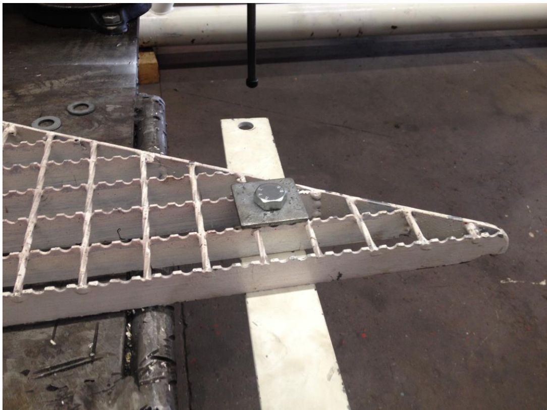
Kuva 32 Tasonkannattimet liitettiin tasoon pulteilla ja muttereilla. Neliövalilevyllä estettiin pultin luiskahtaminen ritilän silmän läpi.
