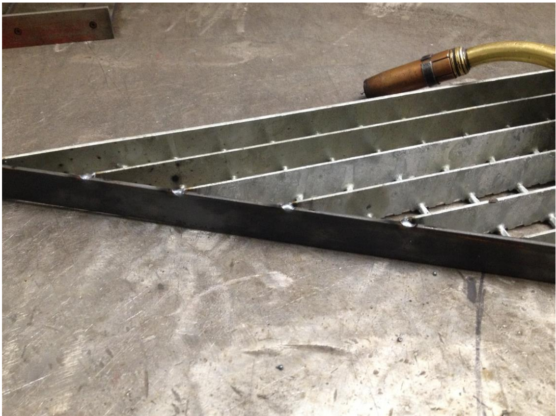
Kuva 25 Ritilään hitsattu vahvike. Hitsaus suoritettiin MIG-hitsauslaitteella.
