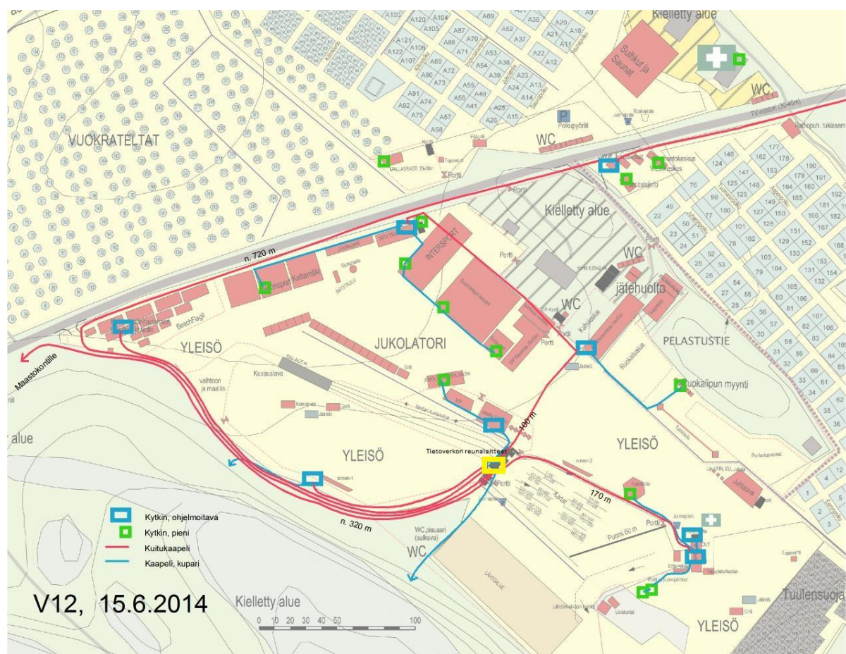
KUVA 3. Kilpailukeskuksen runkoverkon kaapelointi (Hyyryläinen 2014-06-15.)
