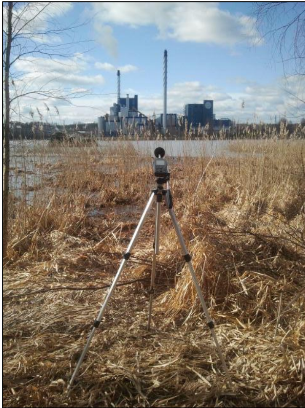
KUVA 12. Melunmittauslaitteisto sijoitettuna Rauhaniemen asuinalueelle.
