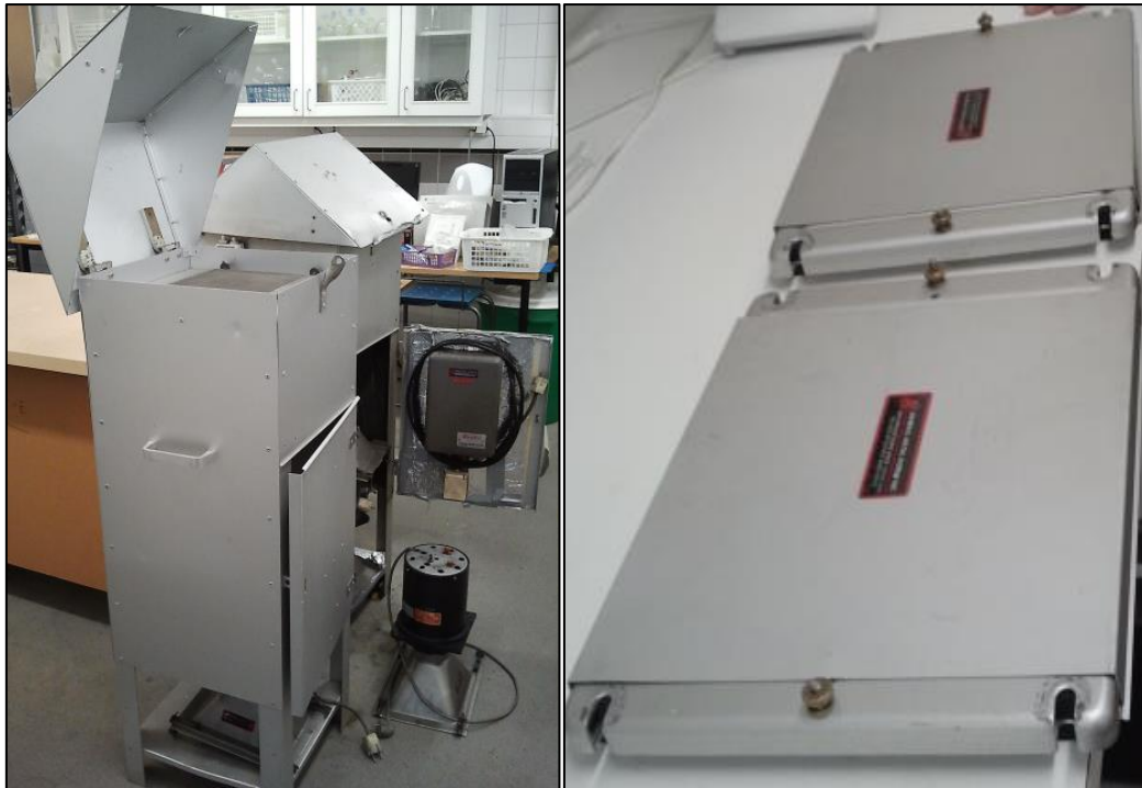
KUVA 6. Mittauksissa käytetyt tehokeräimet (vasemmalla) ja lasikuitusuodattimien suojakotelot (oikealla).
