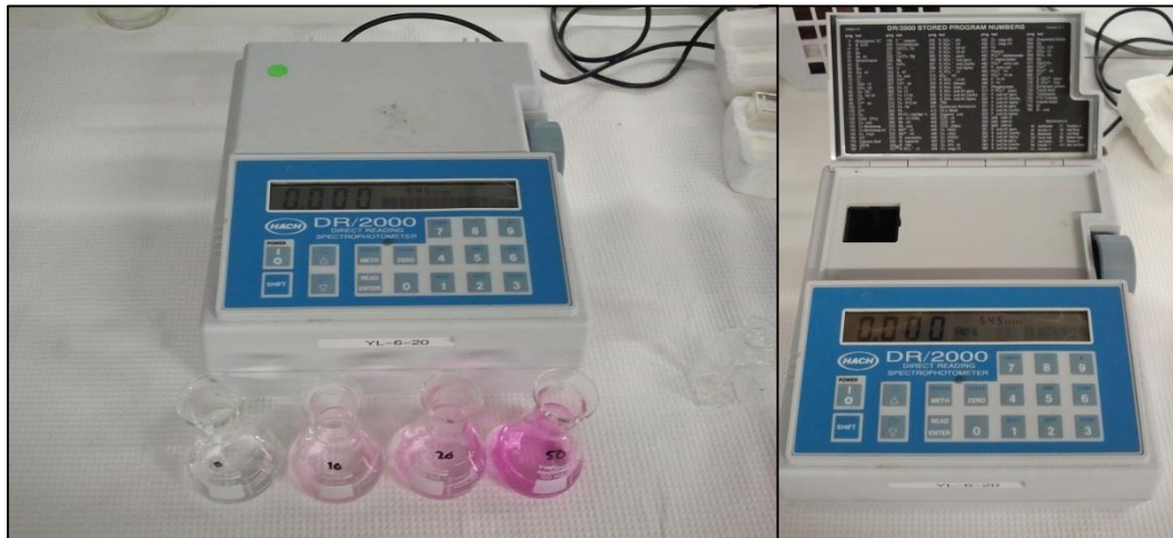
KUVA 15. Nitriitin määritys luminäytteestä. Aallonpituuden mittaaminen spektrofotometrillä.
