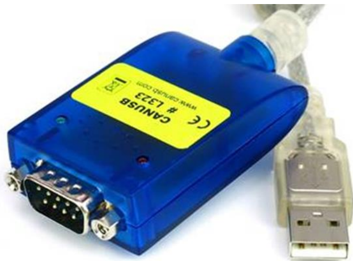
Kuva 13: CAN USB-liitin (Heikkinen sähköposti 31.3.2014)
