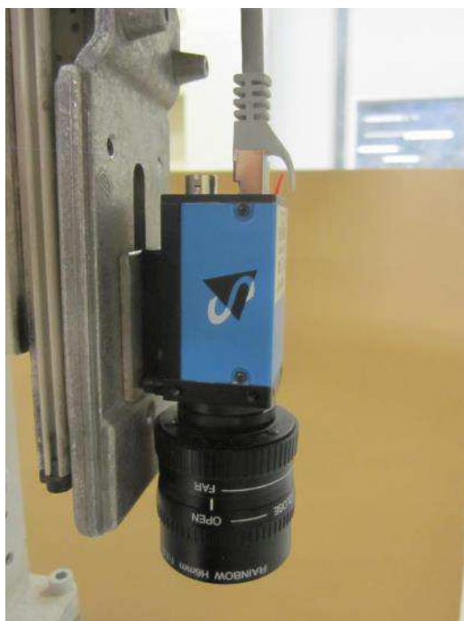
Kuva 15. Uusi kamera asennettuna välilevyn avulla.
