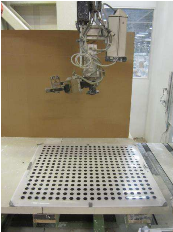
Kuva 17. Robottikameralla tehtävä matriisikalibrointi.
