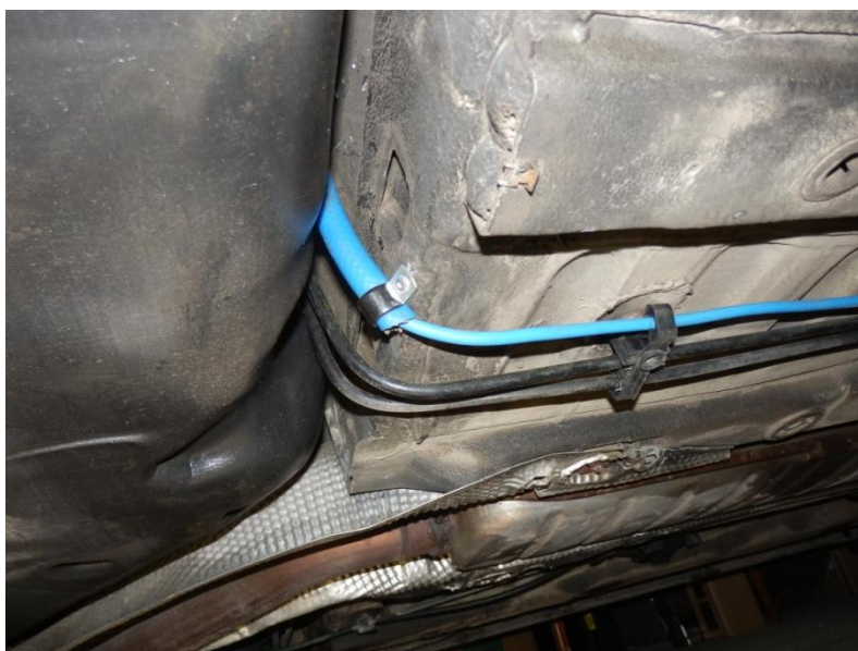
Kuva 19. Kaasuputki, joka kulkee bensiinisäiliön yli ja jatkaa bensiiniputkien vieressä moottoritilaan riittävän etäällä pakoputkesta.
