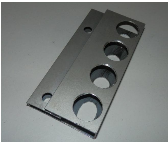
Kuva 23. Alumiiniprofiilista valmistettu suutinpidike.
