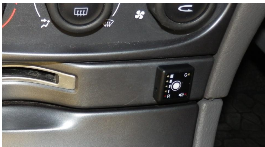
Kuva 27. Keskikonsoliin asennettu kaasujärjestelmän vaihtokytkin sekä led-indikaattori.
