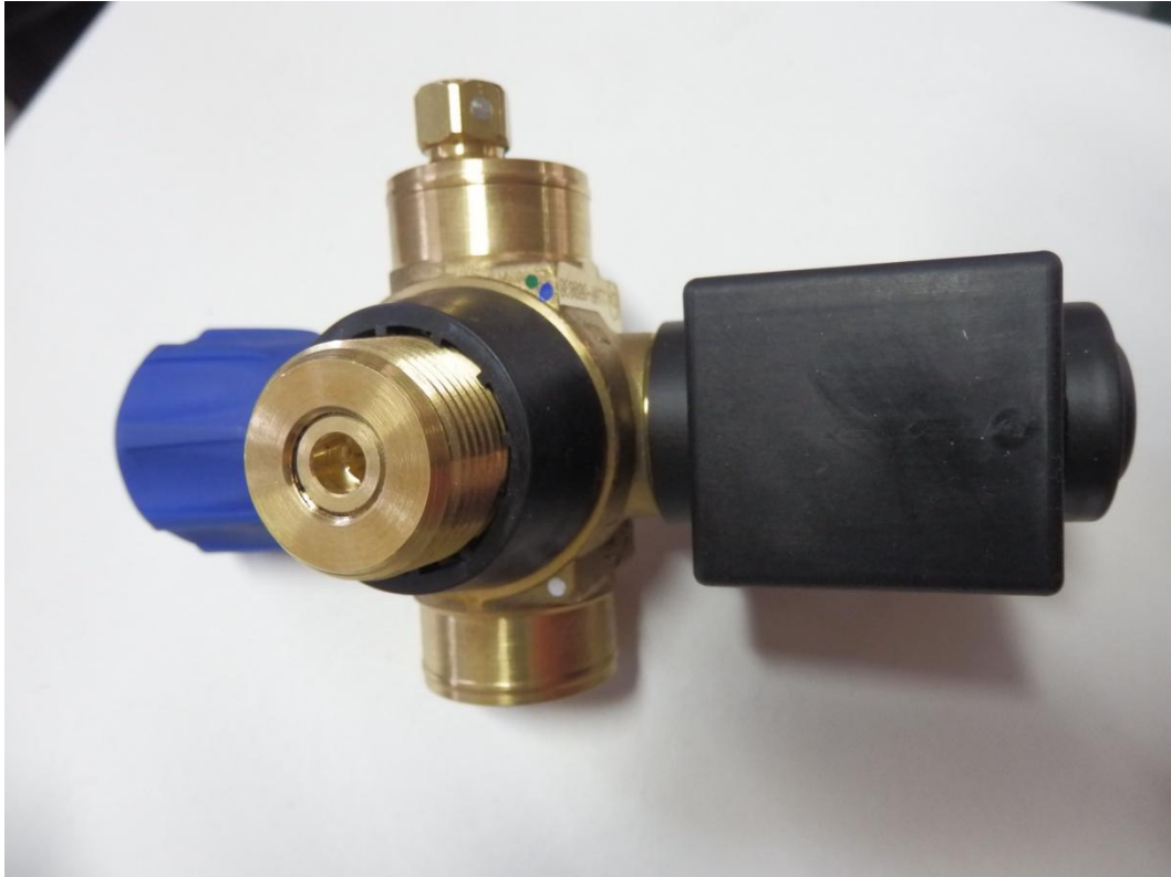
Kuva 4. Tomasetto Achille -säiliöventtiili, jossa on sähkö- ja käsikäyttöinen sulkuventtiili.
