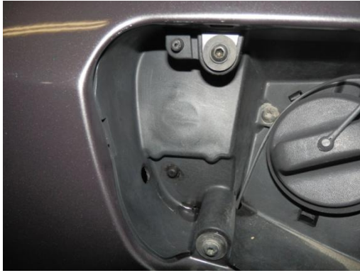
Kuva 11. Tuleva tankkausventtiilin paikka bensiinitankin luukun alla.
