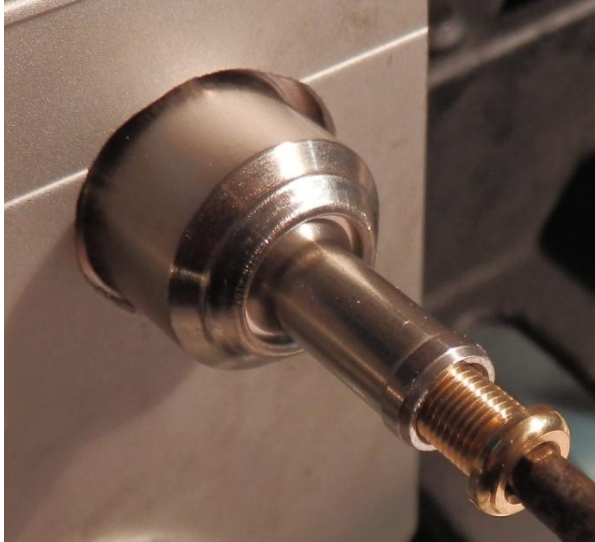
Kuva 9. Suuttimen kärki ja osittain irroitettu suutinputki.
