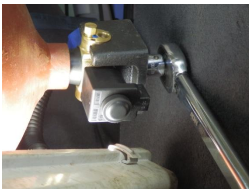
Kuva 18. Säiliöventtiilin kiinnitys kaasusäiliöön, momenttiavaimen ja adapterin avulla.
