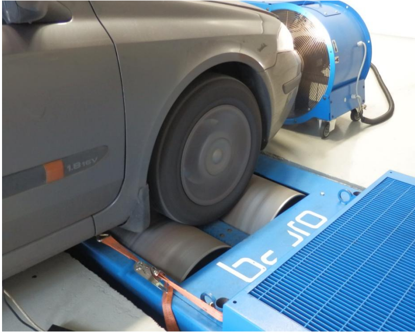
Kuva 33. Laguna tehon mittauksessa ja sidottuna alustadynamometriin. Edessä jäähdytyspuhallin.
