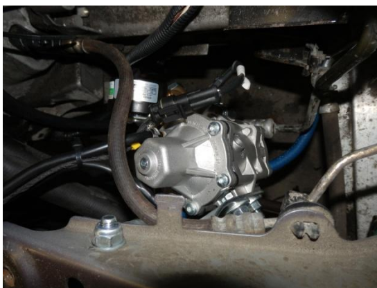
Kuva 22. Paineensäädin paikalleen kiinnitettynä.
