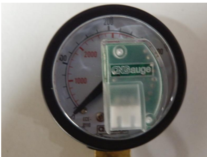
Kuva 6. Painemittari, jossa optinen anturi.
