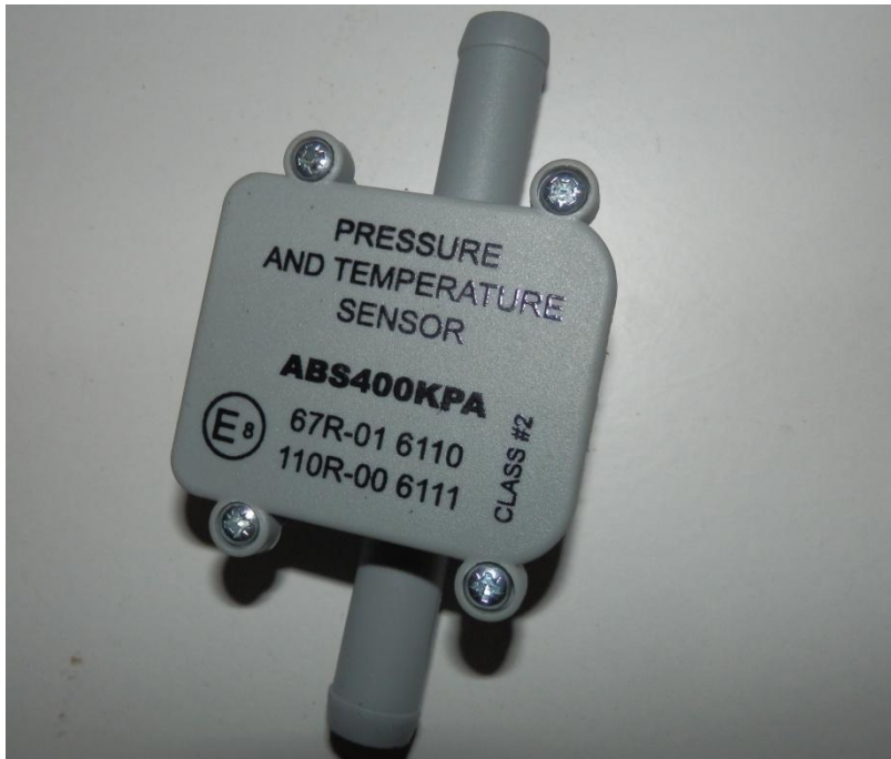
Kuva 8. Kompakti MAP-anturi, matalapaineanturi ja kaasun lämpötila-anturi.
