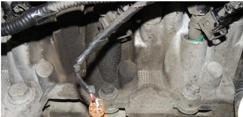
Kuva 12. Imusarjassa bensiinisuihtimien alapuolella valmiit porauspaikat suutinnipoille.
