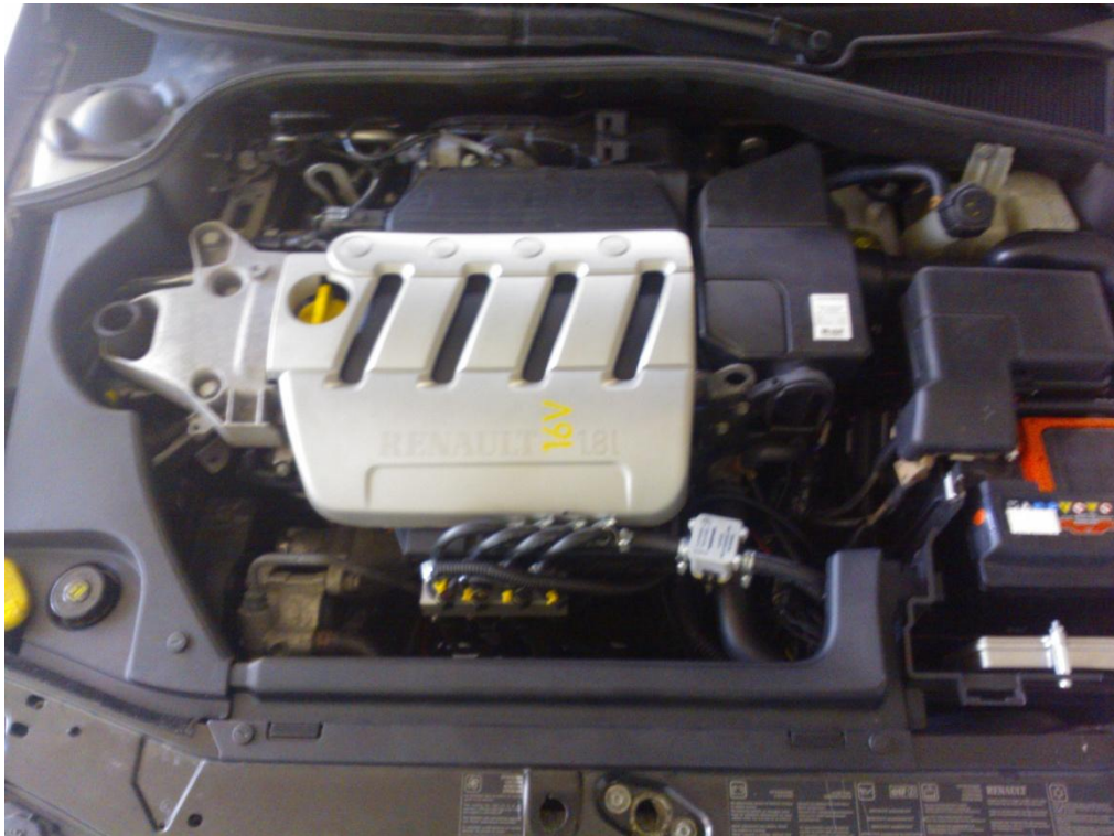
Kuva 28. Kaikki osat paikallaan ja kytkennät tehty. Oikealla alakulmassa kaasu-ECU. Paikallaan ei ole vielä akun suojakansi, jonka alle myös ohjainlaite tulee jäämään.
