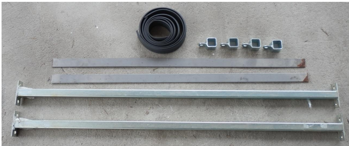
Kuva 13. Kuvassa alimpana sinkityt neliöputket, sekä ylhäällä säiliön kiinnitysspannat ja pantojen kiinnikkeet sekä pantojen ja säiliön väliin tuleva kumi.
