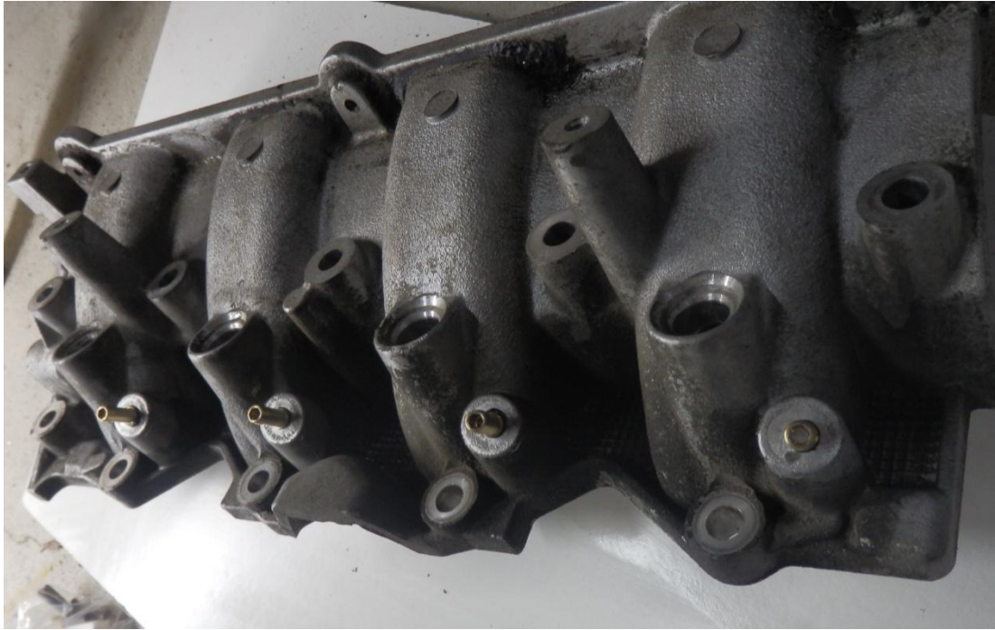
Kuva 21. Suutinnipat kiinnitettyinä imusarjaan.
