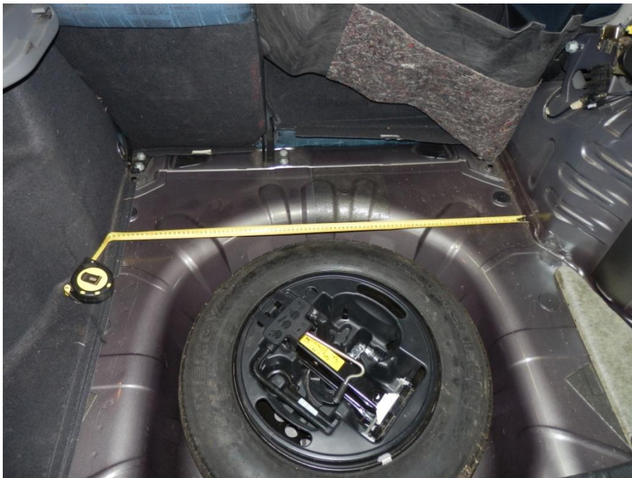
Kuva 10. Kaasusäiliötilan pituuden mittaus ja paikan suunnittelu.
