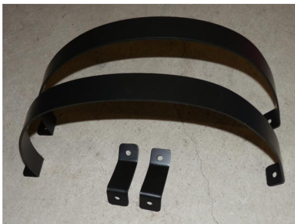
Kuva 15. Valmiit maalatut kaasusäiliön kiinnityspannat.
