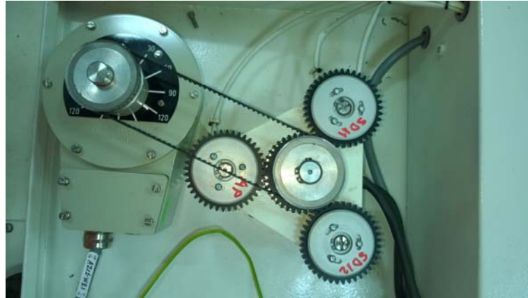
Kuva 10. Resolveriyksikkö ja potentiometri kytkettynä toisiinsa.
