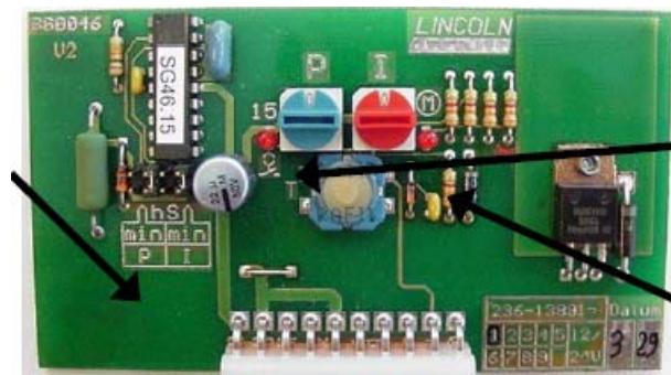
Kuva 4. Rasvapumpun ohjaukortin dippikytkimet ja kiertokytkimet. [5]
