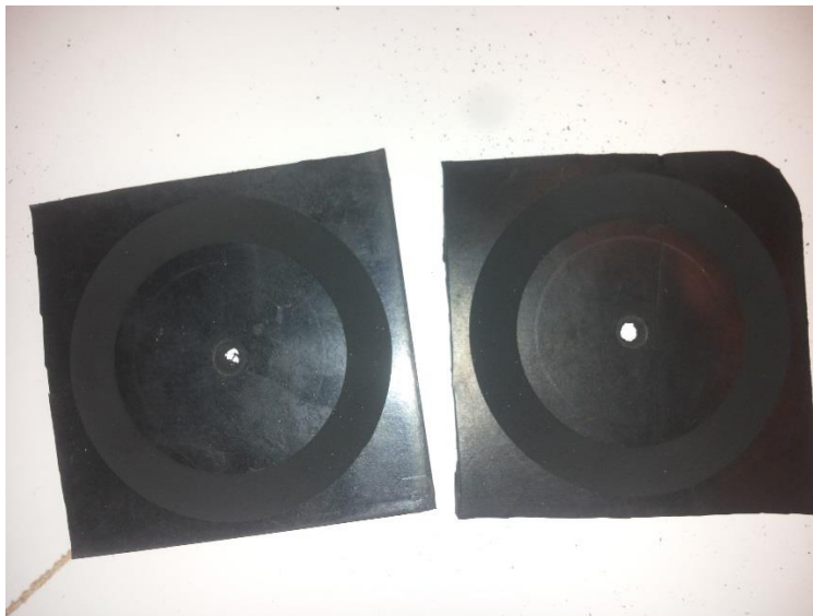
KUVA 9. EPDM-kumimaton palaset Taber-testin jälkeen
