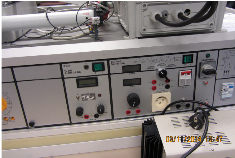
Kuva 9 Testipöytä; tasa- ja vaihtojännitelähde.
