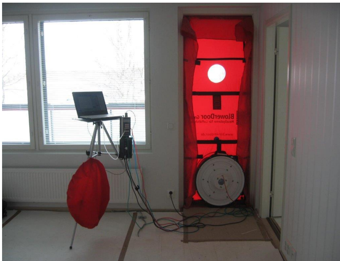
KUVA 1. Tiiveysmittauslaitteiston kokoonpano (Ramest Oy, 2013)
