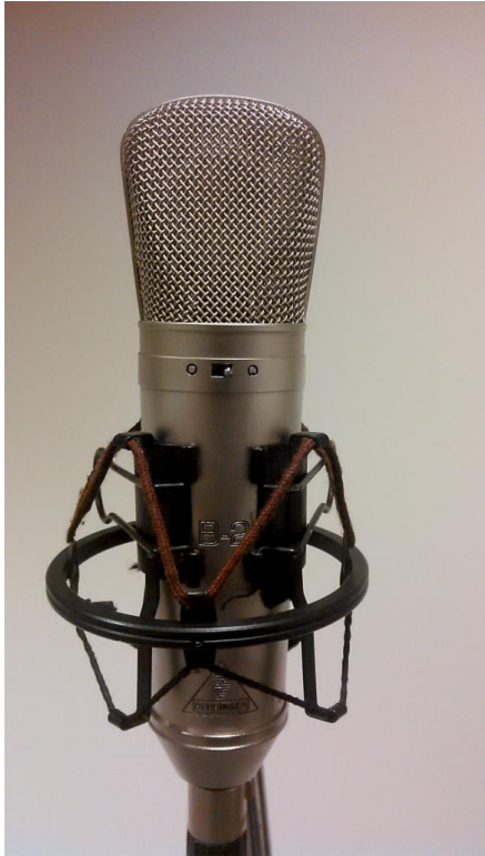
KUVIO 4. Suurikalvoinen kondensaattorimikrofoni.
